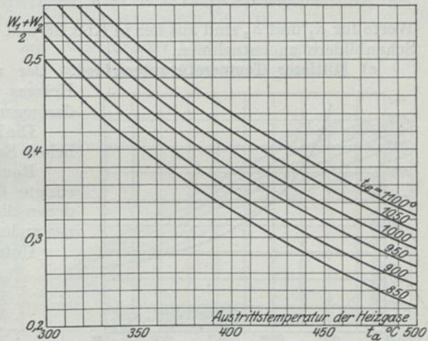
Abb. 39. Wärmewerte  $\frac{W_1 + W_2}{2}$  bei verschiedenen Eintrittstemperaturen  $t_e$  in Abh. von der Austrittstemperatur  $t_a$  der Heizgase.
