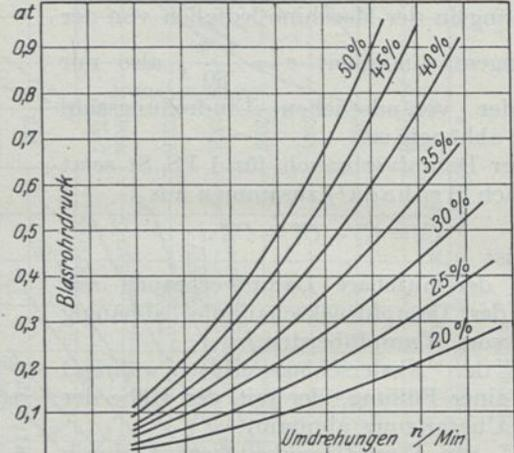
Abb. 60. Blasrohrdruck bei Lokomotive 3.
