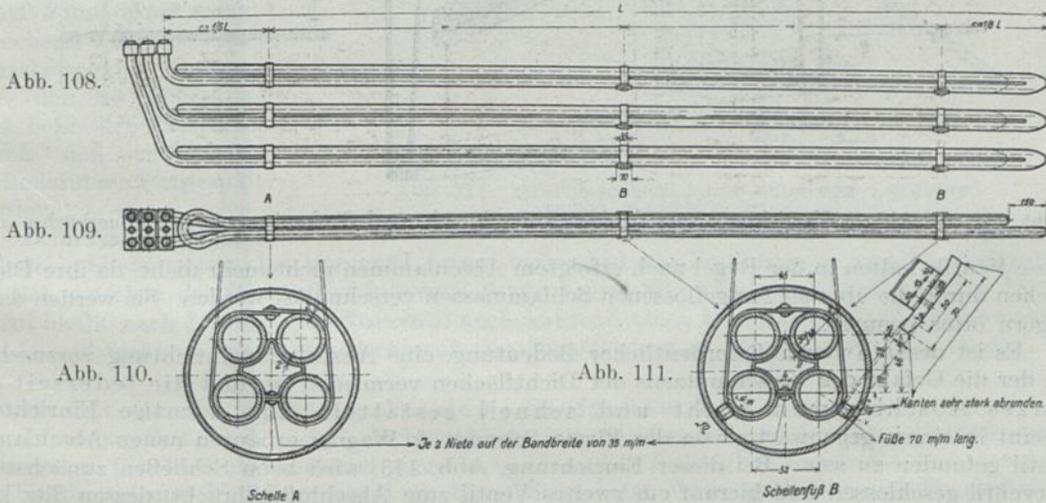
Abb. 108 bis 111. Lagerung des Überhitzerelements im Rauchrohr für Großrohrüberhitzer.
