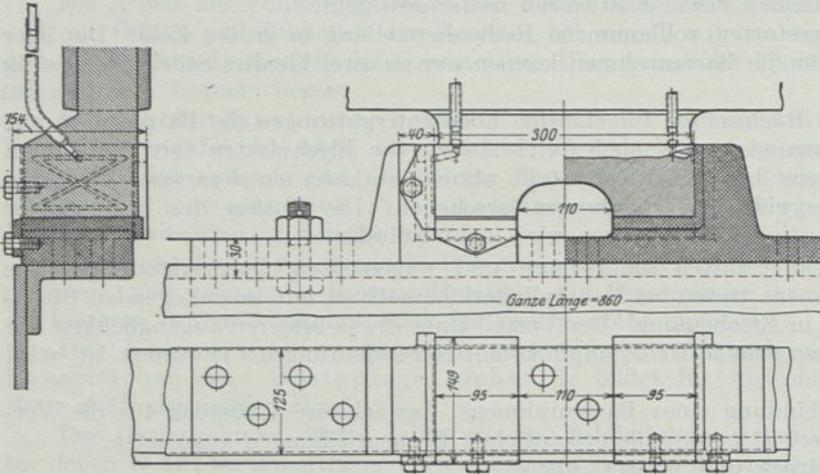
Abb. 75 bis 77. Schlingerstück einer 2 C-Schnellzuglokomotive.
