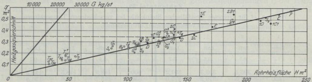
Abb. 50. Freier Siederrohrquerschnitt in Abhängigkeit von der Rohrheizfläche bei Sattdampflokomotivkesseln.
