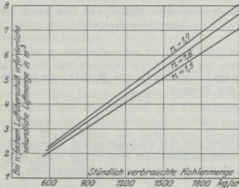
Abb. 52. Luftüberschuß in Abhängigkeit von der stündlichen Brennstoffmenge.
