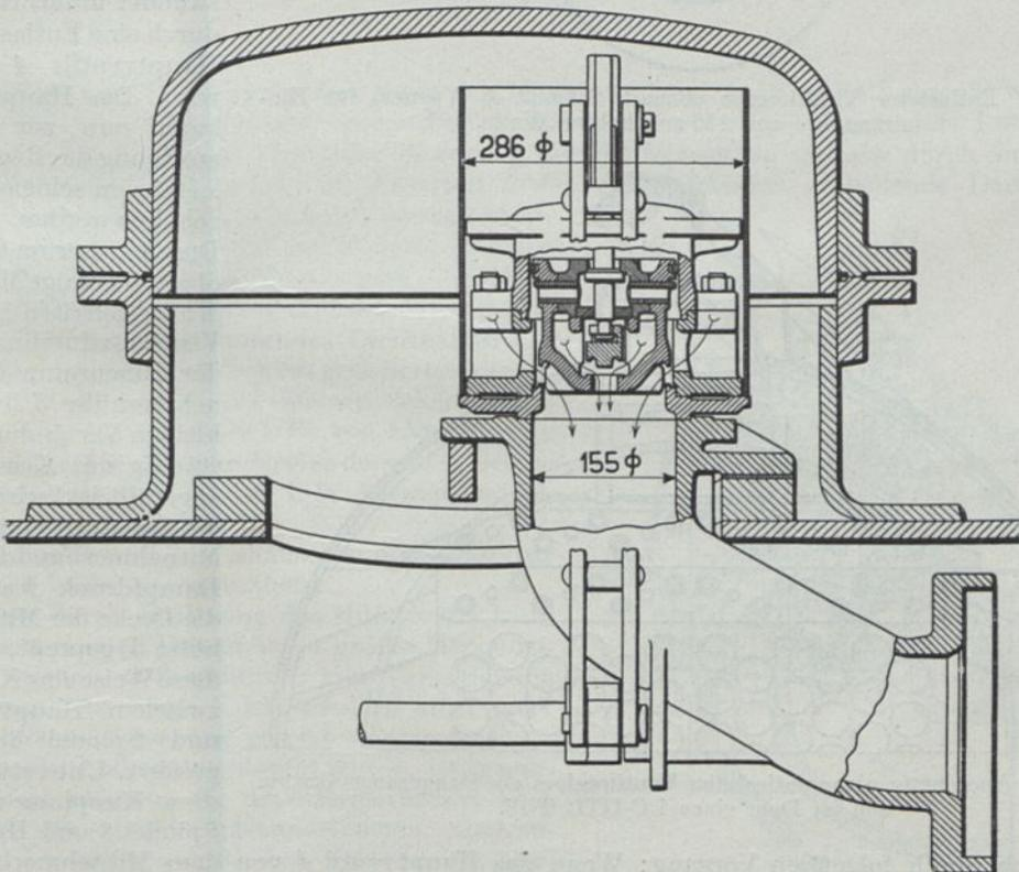
Abb. 92. Entlasteter Ventilregler (Bauart Schmidt & Wagner) für Einströmrohre von 155 mm lichter Weite. (Regler halb geöffnet.)
