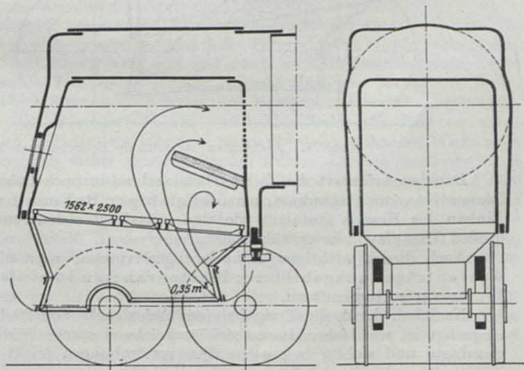
Abb. 72. Aschkasten für breite Feuerbüchsen und Barrenrahmen.
