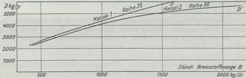
Abb. 64. Verdampfungsverhältnisse bei 2 österreichischen Lokomotiven mit Braunkohlenfeuerung.
