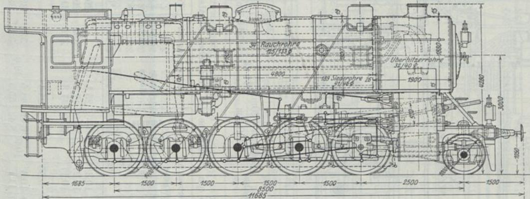
Abb. 16. 1 E-Heißdampf-Drilling-G-Lokomotive der Deutschen Reichsbahn (Preußen).
