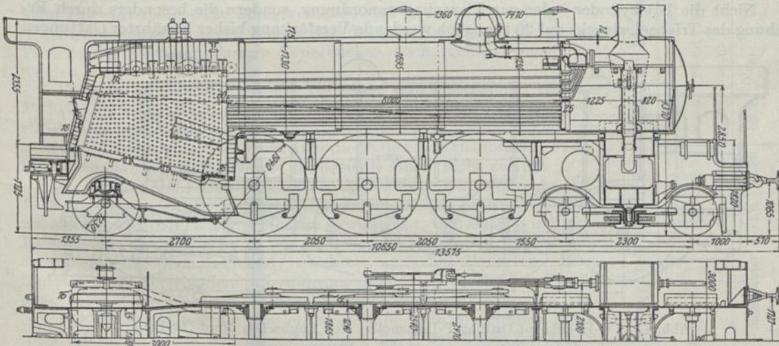
Abb. 2. 2 C 1-Heißdampf-Zwilling-S-Lokomotive der Französischen Südbahn
