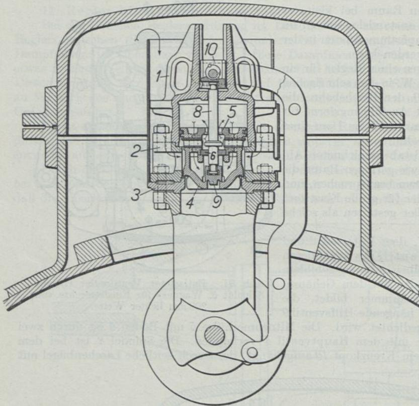
Abb. 93. Entlasteter Ventilregler (Bauart Schmidt & Wagner) für Einströmröhre von 155 mm lichter Weite.
