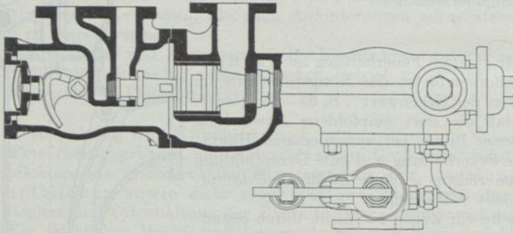
Abb. 87a. Abdampfinjektor Davies & Metcalfe (Längsschnitt und Ansicht von oben).
