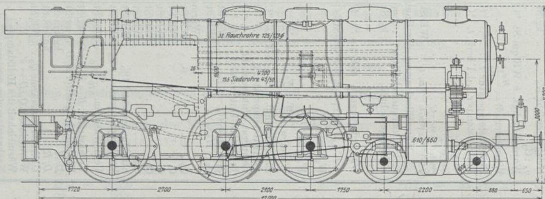
Abb. 116. Entwurf einer auf 20 t Achsdruck verstärkten 2 C-HPL.
