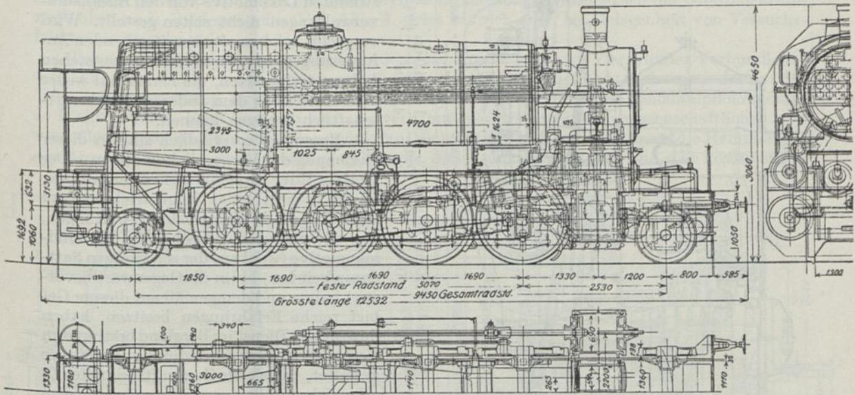
Abb. 6. 1 D 1-Heißdampf-Vierzylinder-Verbund-S-Lokomotive der Österreichischen Staatsbahn.
