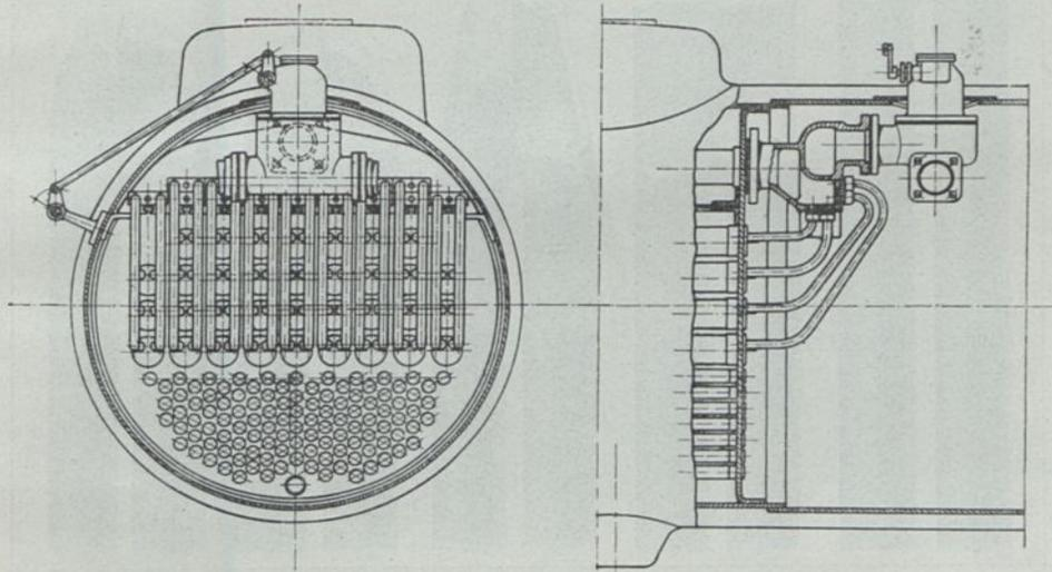
Abb. 100 und 100a. Anordnung eines Ventilreglers am Dampfsammelkasten.
