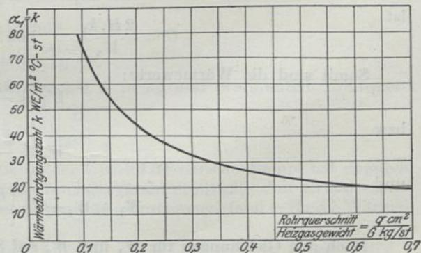
Abb. 38. Wärmedurchgangszahl  $k$  zwischen Heizgasen und Kesselwasser in Abh. vom Verhältnis
