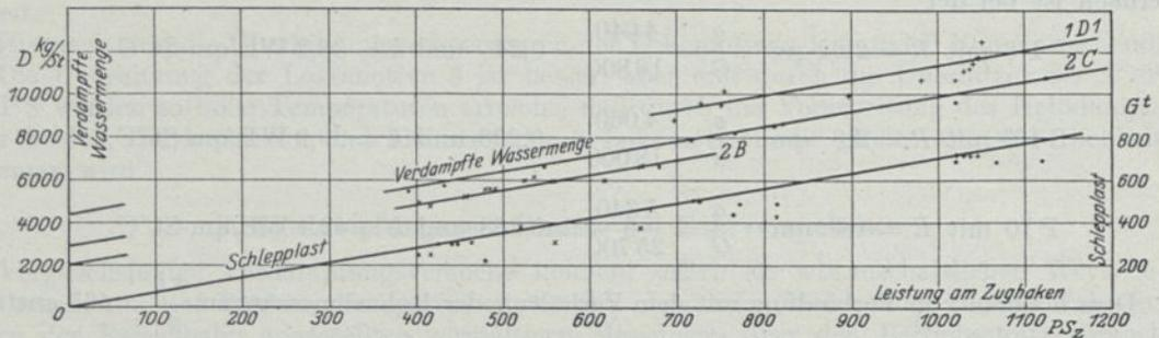
Abb. 66. Verdampfte Wassermengen bei verschiedenen Zughakenleistungen und Schlepplasten auf Flachlandstrecken.
