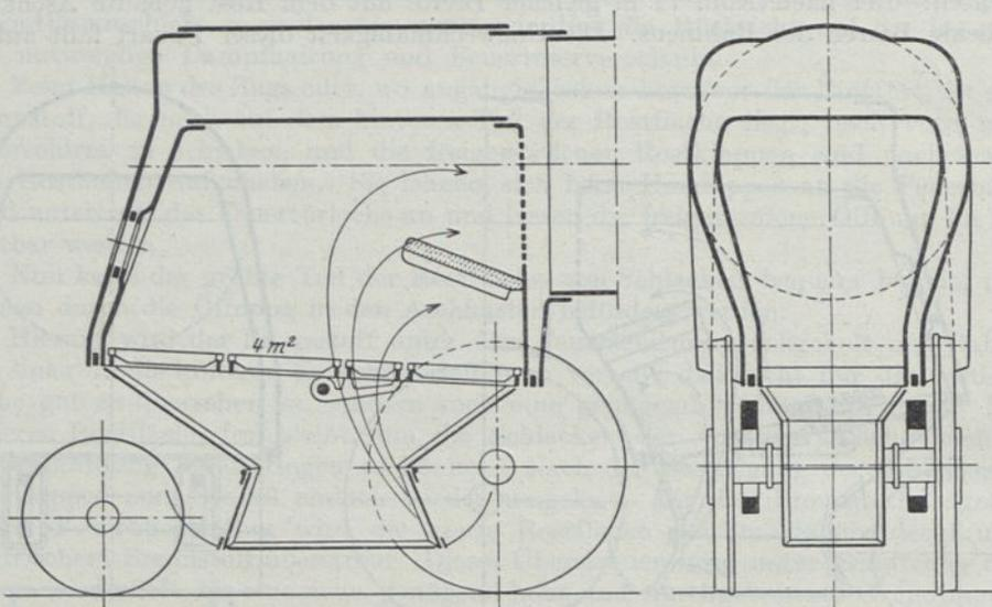
Abb. 73. Aschkasten für schmale Feuerbüchsen bei Barrenrahmen.
