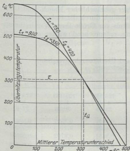
Abb. 41. Überhitzungstemperatur  $t_{\bar{u}}$  in Abh. vom mittleren Temperaturunterschied  $\tau$ .
