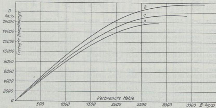
Abb. 54. Erzeugte Dampfmenge in Abhängigkeit von der verbrannten Kohle.
