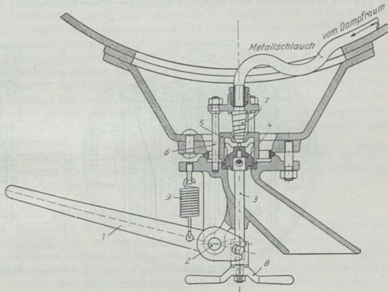
Abb. 113. Abschlammvorrichtung unter dem Langkessel (Bauart Schmidt & Wagner).
