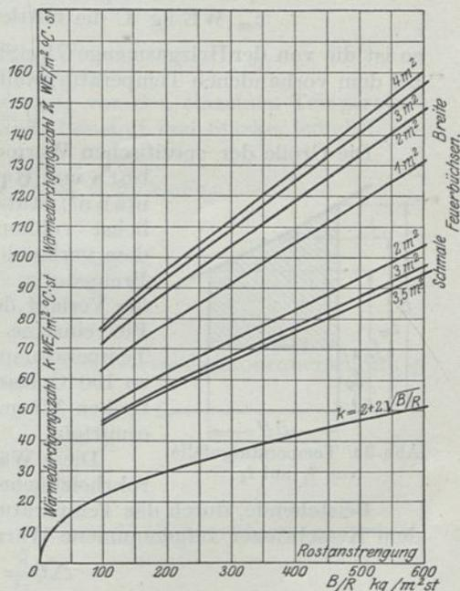
Abb. 34. Wärmedurchgangszahlen bei verschiedenen Rostanstrengungen.
