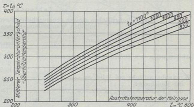
Abb. 42. Überhitzungstemperatur  $t_{\bar{u}}$  bei verschiedenen Eintrittstemperaturen  $t_e$  in Abh. von der Austrittstemperatur  $t_a$  der Heizgase.
