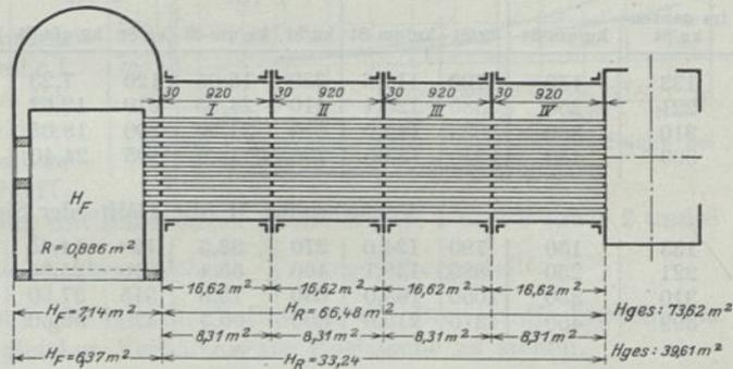
Abb. 27. Versuchskessel der Französischen Nordbahn, 1864.
