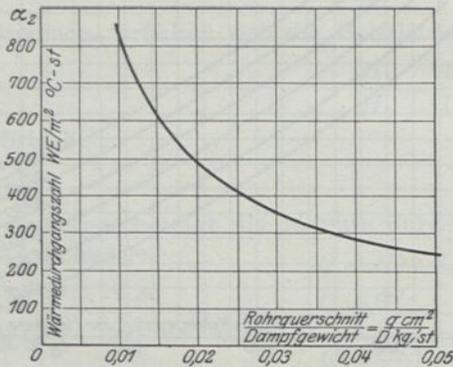
Abb. 40. Wärmedurchgangszahl  $\alpha_2$  zwischen Rohrheizflächen und Heißdampf in Abh. vom Verhältnis  $\frac{q}{D} = \frac{\text{Rohrquerschnitt qcm}}{\text{Dampfgewicht kg/St}}$ .
