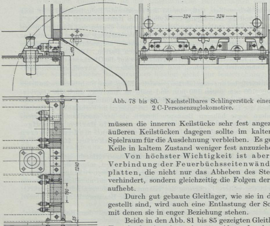
Abb. 78 bis 80. Nachstellbares Schlingerstück einer 2 C-Personenzuglokomotive.
