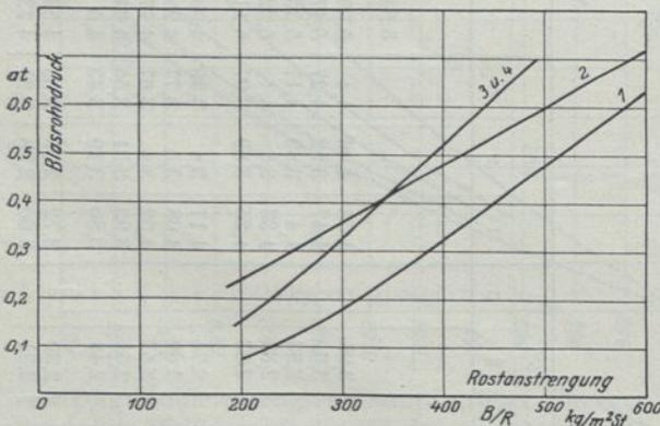
Abb. 61. Blasrohrdruck in Abhängigkeit von der Rostanstrengung  $\frac{B}{R}$ .
