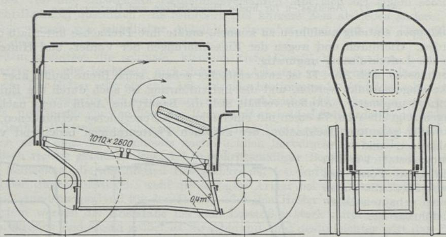
Abb. 74. Aschkasten für schmale Feuerbüchsen bei Plattenrahmen.
