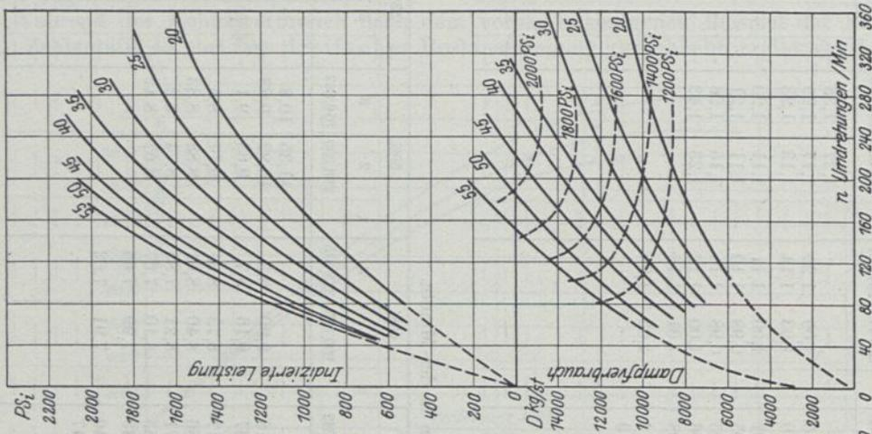
Abb. 58. Lokomotive 3, Indizierte Leistung und Dampfverbrauch bei verschiedenen Füllungen in Abhängigkeit von den Triebbradumdrehungen.
