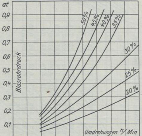
Abb. 59. Blasrohrdruck bei Lokomotive 1.
