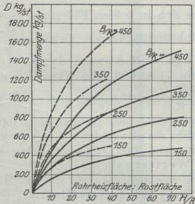
Abb. 30. Auf der Rohrheizfläche erzeugte Dampfmenge in Abh. von  $\frac{H_r}{R}$ .
