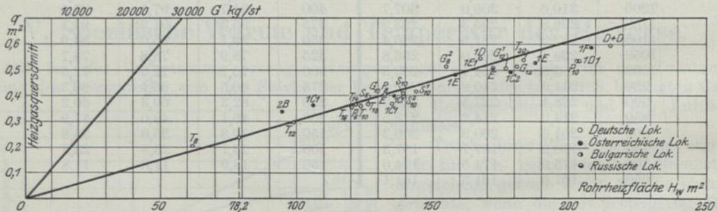
Abb. 51. Freier Siede- und Rauchrohrquerschnitt in Abhängigkeit von der Rohrheizfläche bei Heißdampflokomotivkesseln.
