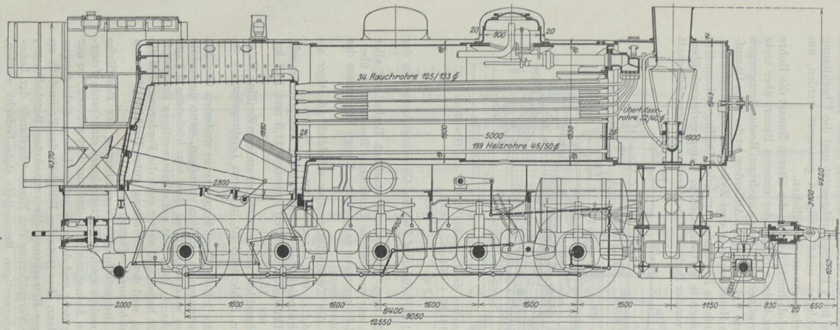
Abb. 17. 1 E-Heißdampf-Zwilling-G-Lokomotive der Polnischen Staatsbahn.  $\frac{650 \text{ mm} \ 720 \text{ mm}}{1450 \text{ mm}}$  14 at  $\frac{223,9 + 73,5 \text{ qm}}{4,5 \text{ qm}}$  85 t  $\frac{85 \text{ t}}{94 \text{ t}}$ .
