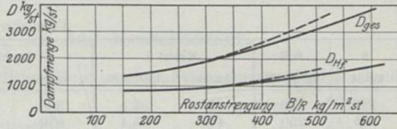
Abb. 28. Durch die Feuerbüchsheizfläche und Gesamtheizfläche erzeugte Dampfmenge bei verschiedenen Rostanstregungen.
