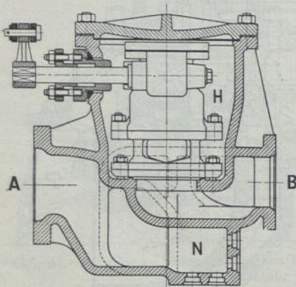
Abb. 99. Anordnung eines im Dampfsammelkasten eingebauten Ventilreglers (Entwurf).
