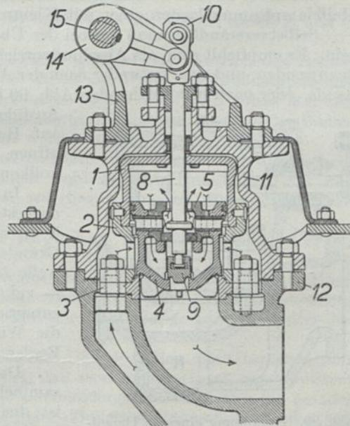
Abb. 96. Entlasteter Ventilregler am Dampfsammelkasten.
