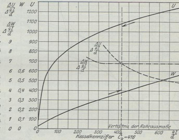
Abb. 46. Veränderlichkeit des Wärmeübertragungswerts  $U$  und Wärmewerts  $W$  bei verschiedenen Rohrausmaßen.
