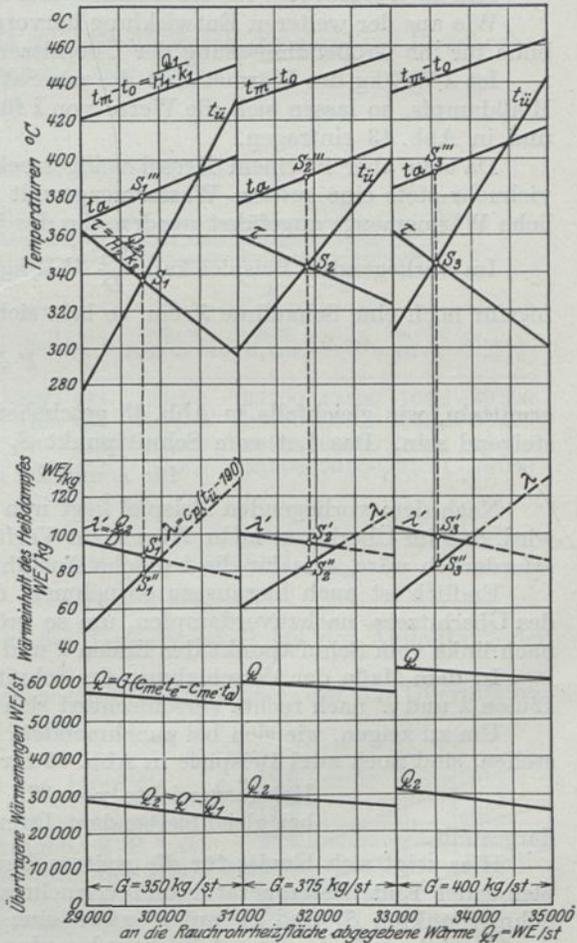
Abb. 43. Verschiedenartige Übertragungsmöglichkeiten der Heizgaswärme durch die Rauchrohr- und Überhitzerheizfläche.
