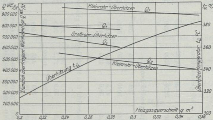
Abb. 48. Wärmeübertragung von Großrohr- und Kleinrohrüberhitzer verschiedener Bauart.
