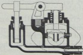
Abb. 88. Abdampfinjektor Davies & Metcalfe (Querschnitt durch das Schlabberventil).
