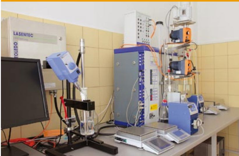
Wielozadaniowy reaktor-kryształizator z pomiarem on-line rozkładu rozmiarów kryształu
