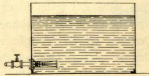
Behälter mit Körtling's Dampfstrahl-Anwärmvorrichtung.
