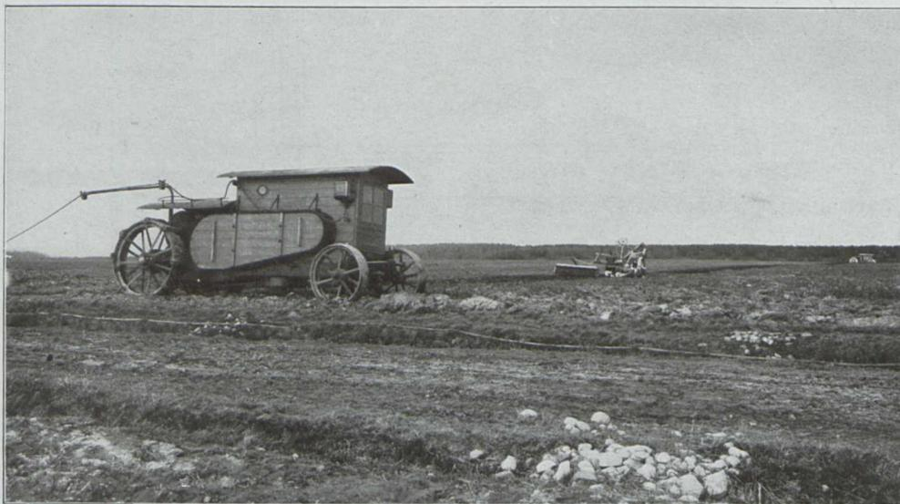
Fig. 30. Elektropflug nach dem Zweimaschinensystem.
