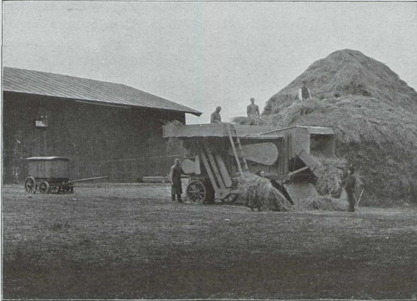
Fig. 25. Ausdrusch auf dem Felde. Dreschmaschine durch fahrbaren Elektromotor angetrieben.
