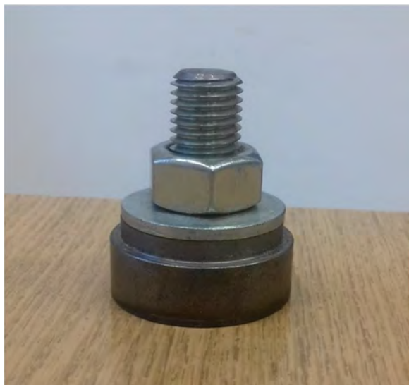
Rys. 5.7. Denko stalowe modelujące podstawę pala
