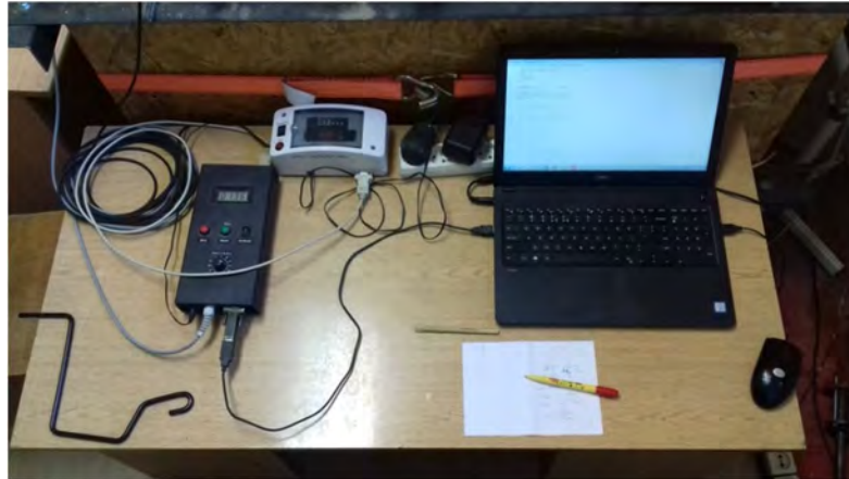
Rys. 5.13. Stanowisko komputera z podłączonymi czujnikami siły i przemieszczeń
