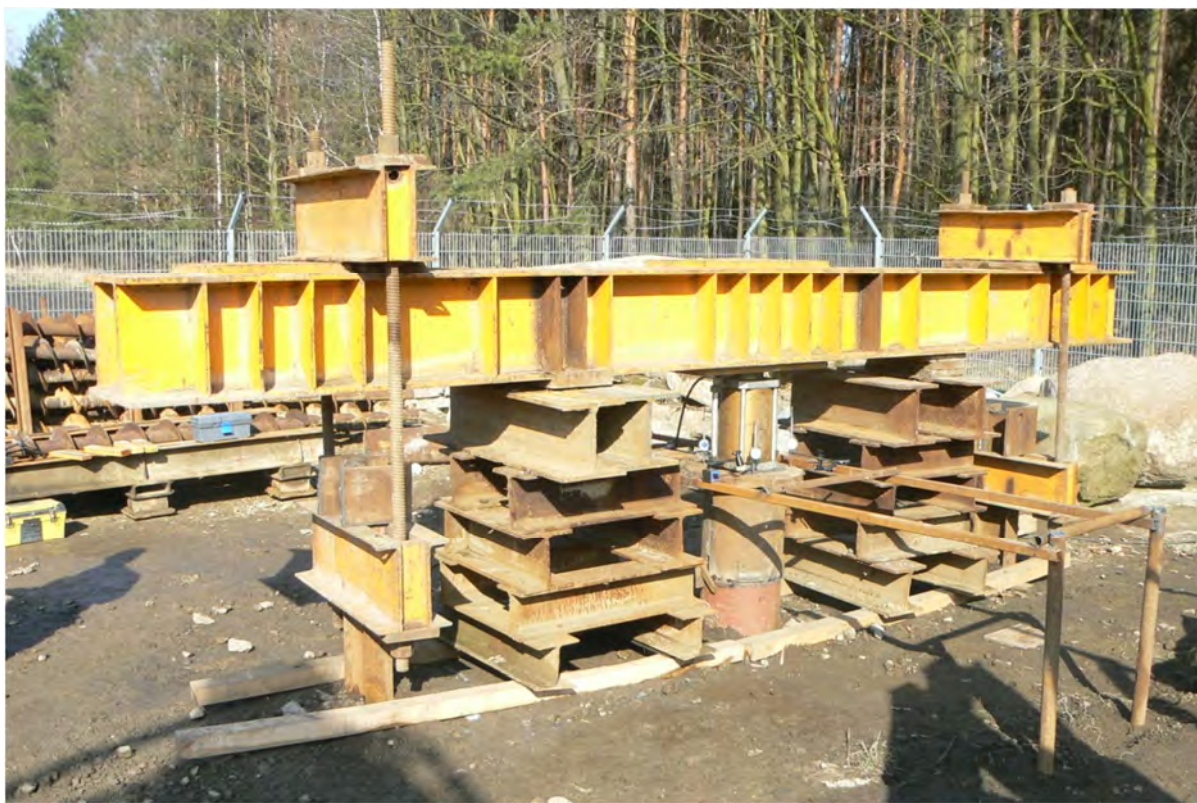
Rys. 4.12. Stanowisko badawcze do przeprowadzenia standardowych próbnych obciążeń statycznych 27.02.2016 r. i 19.03.2016 r.
