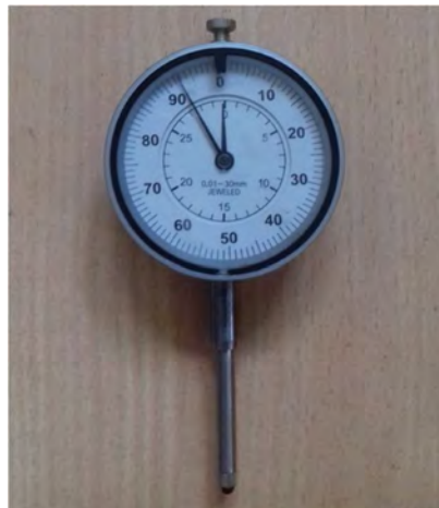
Rys. 5.14. Analogowy zegarowy czujnik przemieszczeń wykorzystany w teście samozrównoważnym
