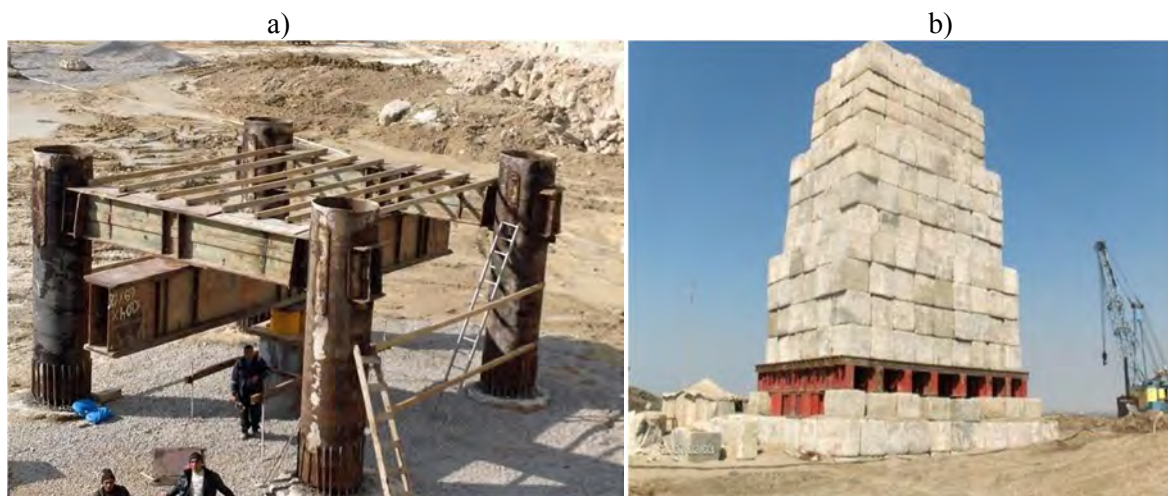
Rys. 2.6. Próbne obciążenie statyczne z konstrukcją oporową realizowaną za pomocą a) pali kotwiących (nafundamente.ru) b) balastu (piletest.eu)
