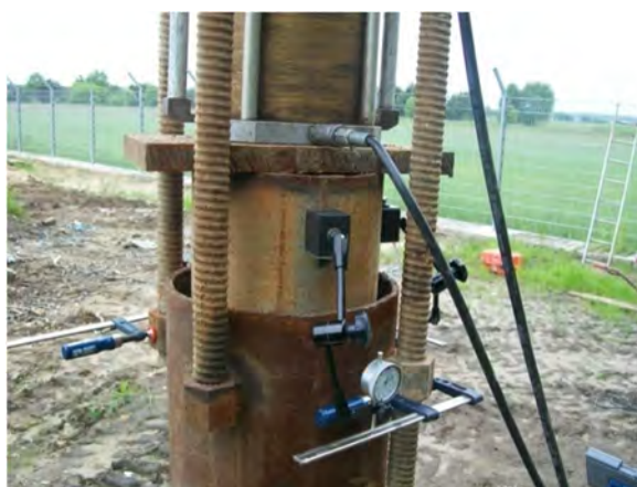
Rys. 2.7. Przykładowe zastosowanie czujników pomiarowych zamontowanych na stanowisku badawczym autora
