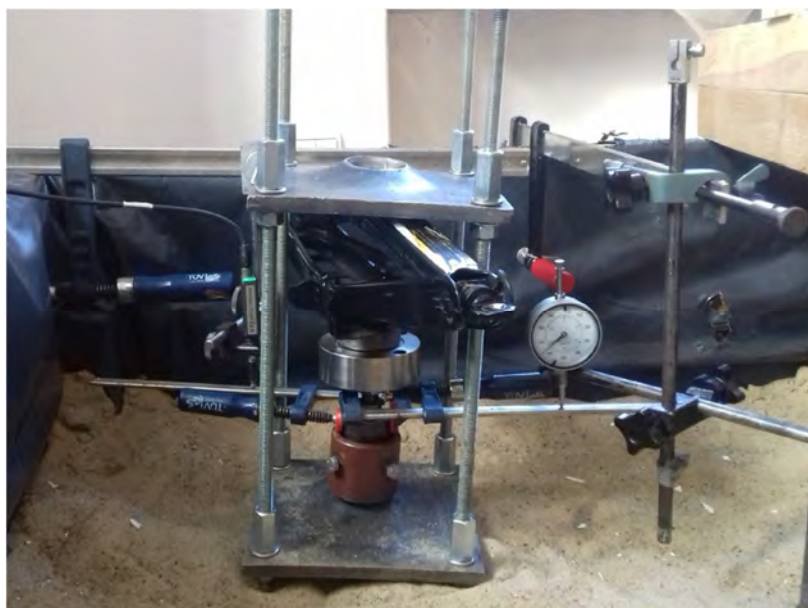
Rys. 5.19. Stanowiska do badań samozrównoważonych na modelach pali
