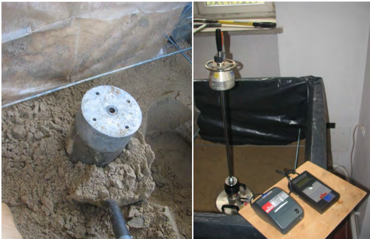
Rys. 5.5. Badanie gruntu w skrzyni za pomocą cylindra i płyty dynamicznej
