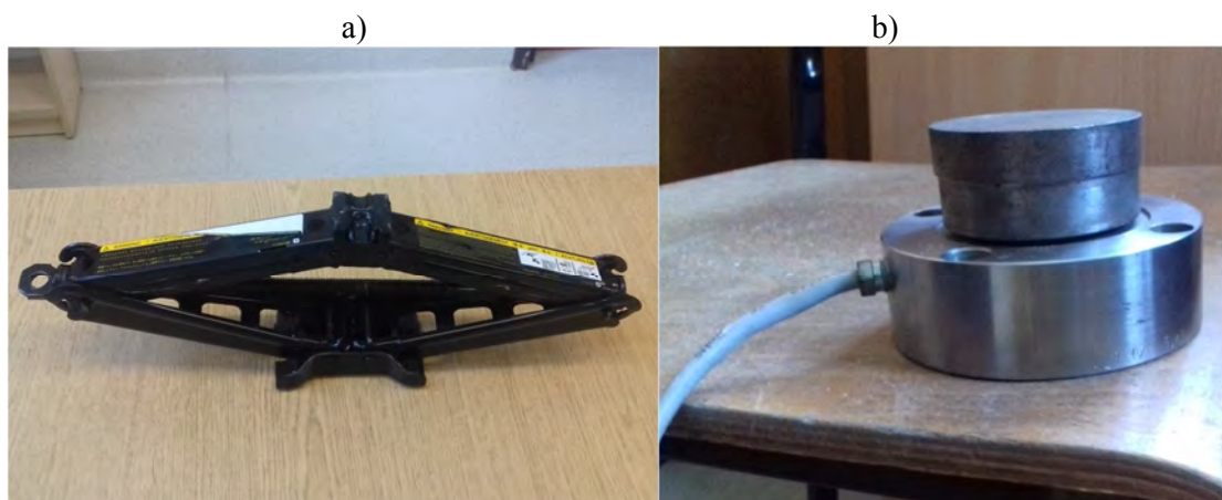
Rys. 5.11. Podnośnik samochodowy użyty do wywierania siły (a) i czujnik do pomiaru przykładanej siły (b)
