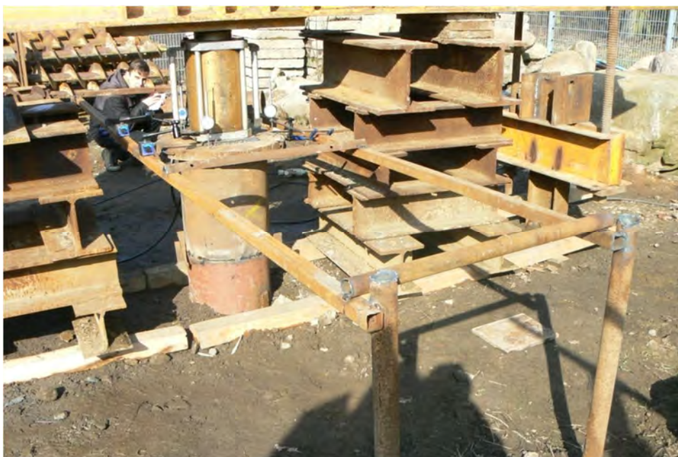
Rys 4.15. Stanowisko badawcze z czujnikami przemieszczeń zamontowanymi do niezależnej bazy pomiarowej
