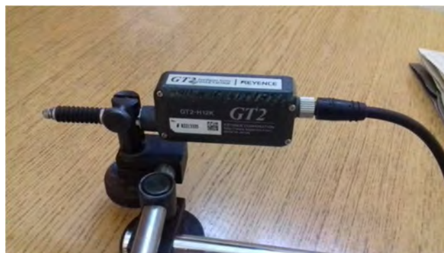
Rys. 5.12. Elektroniczny czujnik przemieszczeń wykorzystany w badaniach
