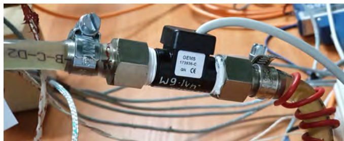
Rys. 5.17 Zastosowany turbinowy przepływomierz 173936-C z serii FT-100 firmy Gems Sensors and Controls .
