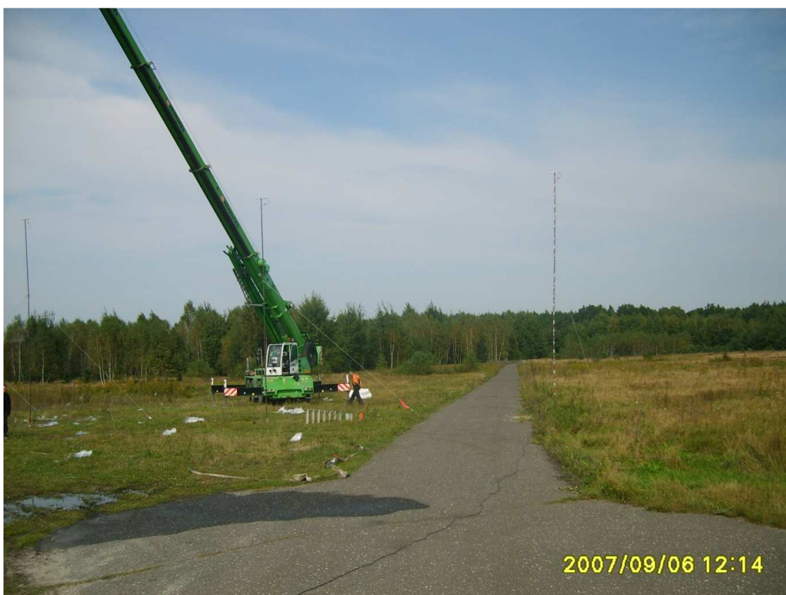
Rysunek 6.1.3. Stanowisko pomiarowe - czujniki ciśnienia umieszczone na wysokości 8 m nad ziemią
