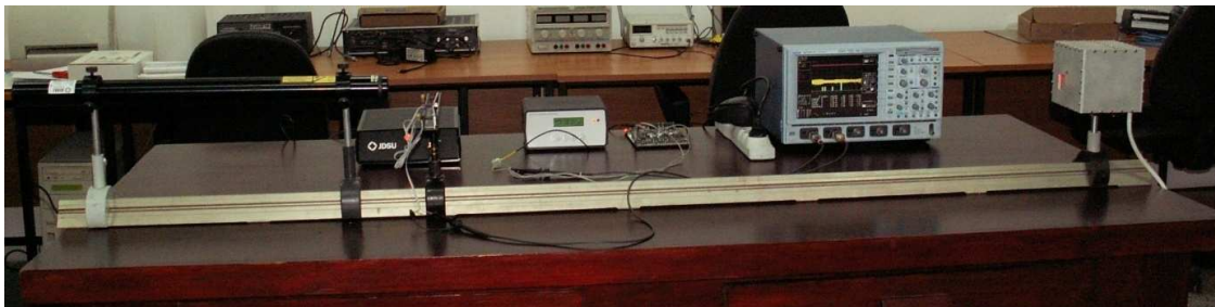
Rysunek Z.4.3. Fotografia stanowiska do wyznaczania czasu otwarcia migawki rejestratora
