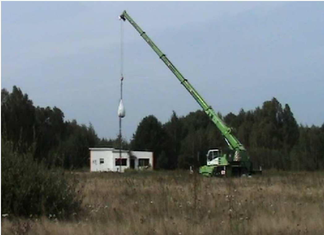
Rysunek Z.2.1. Stanowisko do pomiaru średnicy chmury aerozolu wodnego. Punktem odniesienia do określenia średnicy chmury jest szerokość budynku za kapsułą wodną
