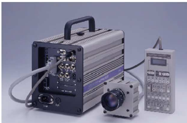
Rysunek 6.2.8. Szybka kamera FASTCAM – ultima 1024, używana do rejestracji rozprzestrzeniania się chmury aerozolu wodnego
