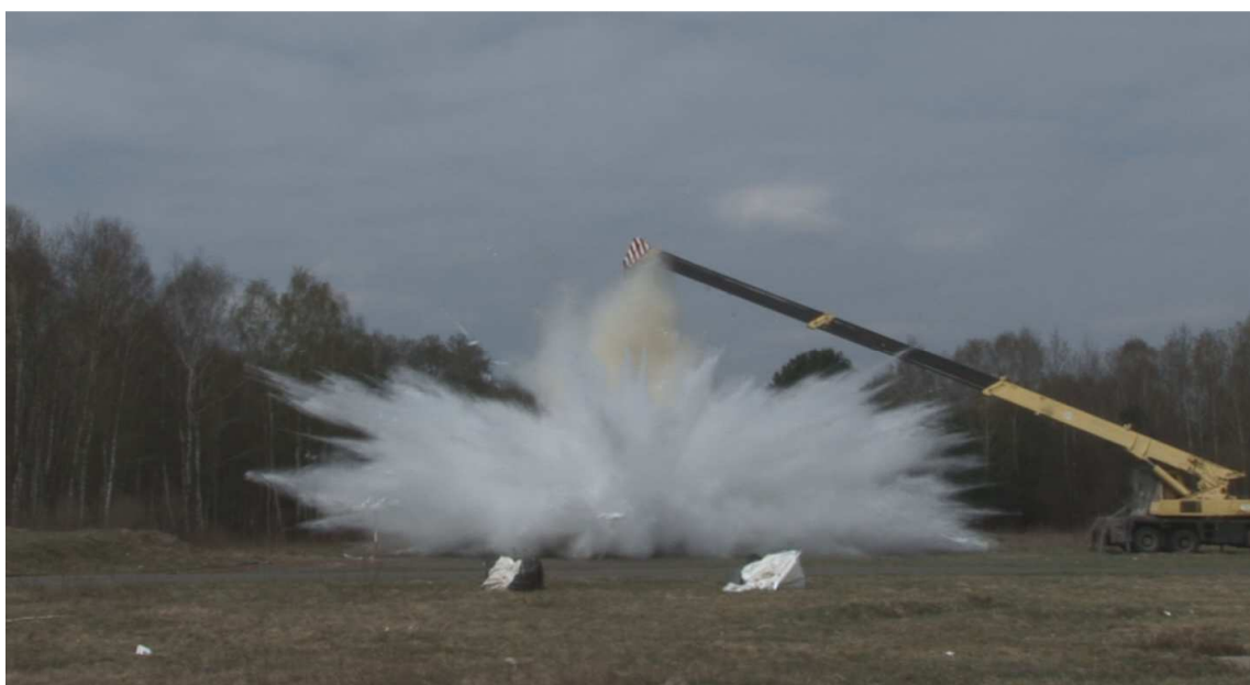
Rysunek 6.5.2.4.7. Kilkadziesiąt milisekund po detonacji materiału wybuchowego zgromadzonego w kapsule rejestrator kropel zostaje „objęty” zasięgiem działania aerozolu. Duża ilość aerozolu wpadającego na rejestrator była przyczyną komplikującą pomiar wielkości kropeł (należało właściwie dobrać odpowiednie parametry rejestratora aby płytka szklana nie została zalana wodą)
