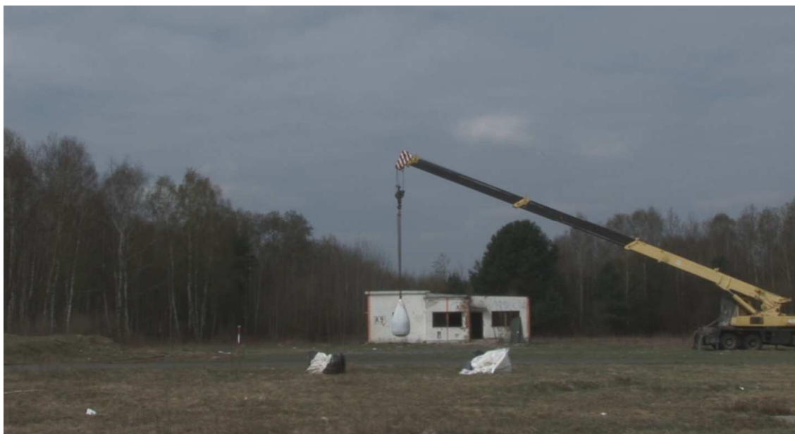
Rysunek 6.5.2.4.5. Widok stanowiska doświadczalnego. W środku kadru widoczna jest kapsuła wodna przygotowana do detonacji, po lewej stronie worka widoczny jest rejestrator kropeł (w odległości 10 m od centrum wybuchu)
