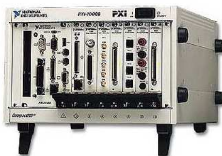
Rysunek 6.1.1B. Komputer przemysłowy PXI użyty w drugim etapie doświadczeń – pomiar ciśnienia na drodze fali uderzeniowej
