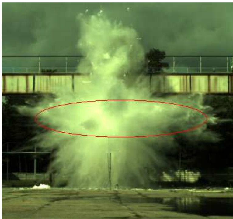
Rysunek 6.2. Pomiar średnicy chmury aerozolu wodnego – wyznaczana jest odległość między zewnętrznymi „obrysami” elipsy
