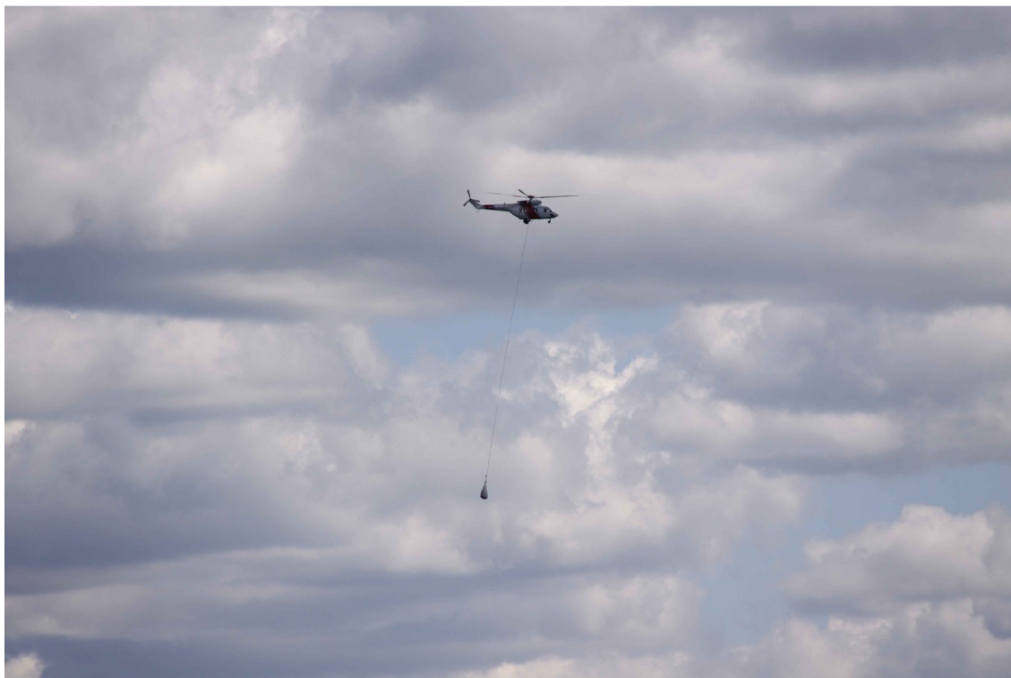
Rysunek 2.2.1. Sposób podwieszenia kapsuły wodnej pod helikopterem
