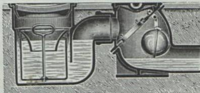
Abb. 81. Selbsttätiger Rückstauverschluß mit vorgeschaltetem Sinkkasten.
