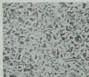
Fig.45 Dureté Brinell = 143 Réjilience = 46 Kg/cm 2 Durée = { 4220 (7) 1110 (15)
