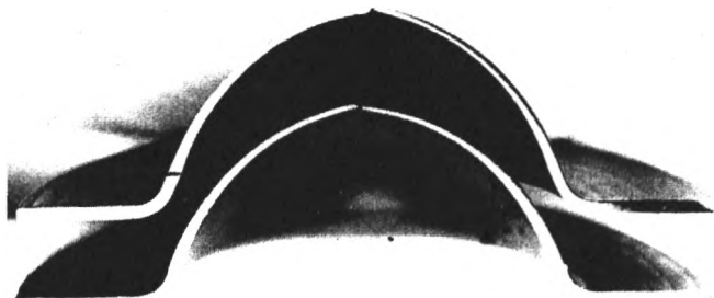
Rys. 3.26. Przekroje wytłoczek pękniętych w biegunie
