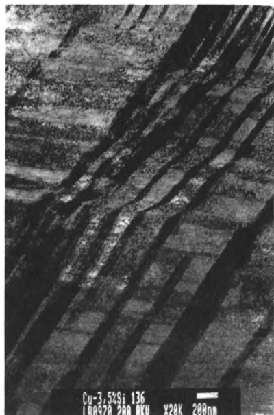
Rys. 1.53. Wzajemnie przecinające się grupy bliźniaków w brązie \text{CuSi}_{3,5} odkształcanym w temperaturze otoczenia, mikroskop elektronowy (warunki odkształcania jak na rys. 1.52)
