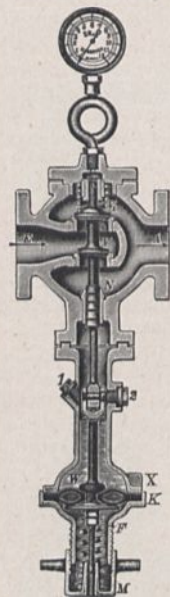
Abb. 170. Dampfdruck-reduzierventil von Dreyer, Rosenkranz & Droop, Hannover. Ventil-entlastung durch Doppelsitz. Druckaufnahme durch Kissenmembran. Einstellung der Gegenkraft durch Federn.
