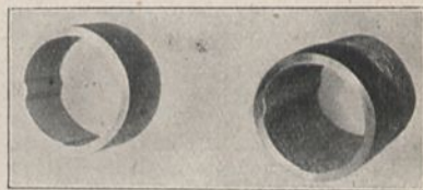
Abb. 2. 1\frac{1}{4} ''-Rohr mit Schlackeneinschluß im Blech. Beginn der Blasenbildung links. Unten ist die Schweißnaht an einer geringen Stauchung des linken Blechteiles zu erkennen.
