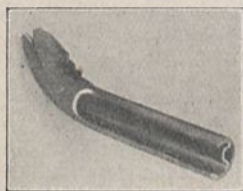
Abb. 1. \frac{3}{4} ''-Rohr mit Blasenbildung infolge Schichtbildung im Blech.
