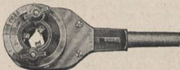
Abb. 34. Einschenklige Gasgewinde-Schneidkluppe (Ratschenkluppe) der Firma Bernhardt, Dresden, mit verstellbaren, dreiteiligen Backen.
