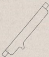
Abb. 110. Stab eines Schrägrostes.
