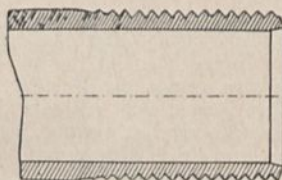
Abb. 31. Konisch auslaufendes, zylindrisches Gewinde auf stumpf geschweißtem Rohr.
