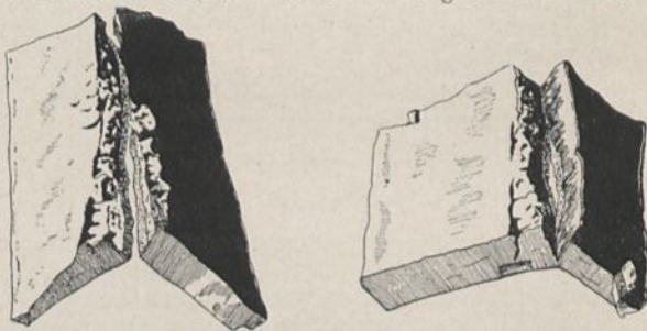
Abb. 30. Schlechte Schweißungen (Federzeichnungen nach der Natur). Linke Probe: Die Bleche klaffen vorn auseinander, hinten standen sie dicht zusammen. Das eingeschmolzene Eisen hat sich mit dem linken Blech gut verbunden, rechts erfolgte nur eine oberflächliche Verschmelzung, ähnlich der Darstellung Abb. 28. Hinten erfolgte nur eine Verschweißung des (unteren) Blechrandes, entsprechend Abb. 27. Die rechte Probe zeigt ähnliche Fehler, das eingeschmolzene Eisen hat aber auch links nur stellenweise Verbindung über die ganze Blechtiefe.
