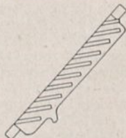
Abb. 111. Stab eines Treppenrostes mit schräg liegenden Roststäben und angegossenen Treppenteilen.
