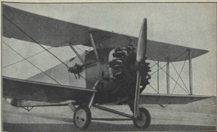
Hawker „Woodcock II“ (1925) KJ 1; E: T. O. M. Sopwith b = 9,80 m; l = 7,12 m; M: Bristol 450 PS-HP-CV; Bst.: H, St.
