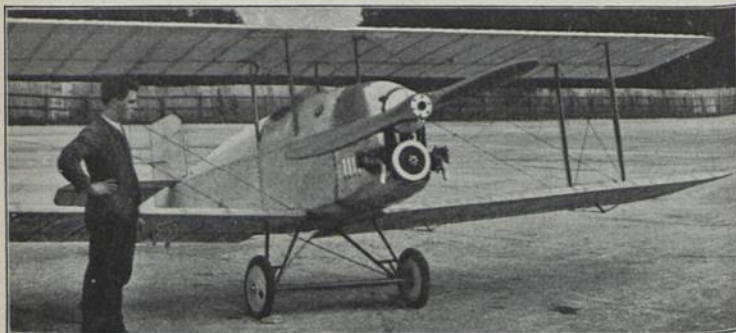
Vickers „Viget“ (1923) Sp 1 b = 7,62 m; l = 5,21 m; T = 18,60 m 2 ; L = 0,17 t; N = 0,08 t; G = 0,26 t; V = 94 km/h; M: Douglas 24 PS-HP-CV; Bst.: H. St.
