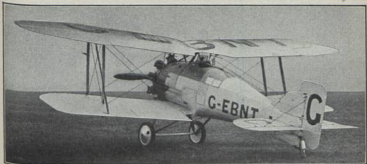
Gloster „Gamecock“ (1926) KJ 1; E: P. Folland b = 8,85 m; G = 1,33 t; M: Bristol 450 PS-HP-CV; Bst.: H. St.
