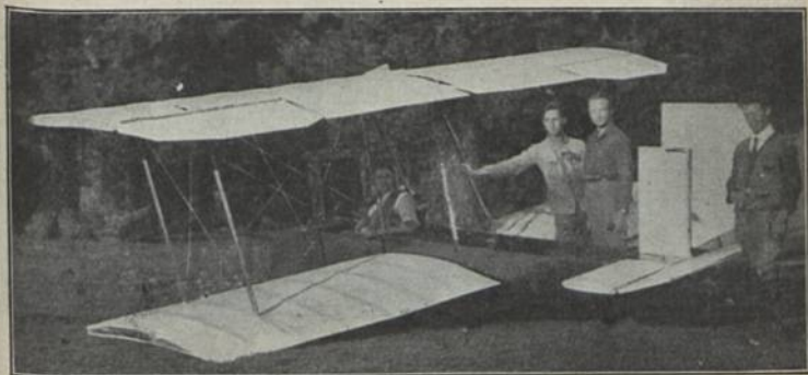
Graz „Kautz“ (1925); E: Jaffmann, Harnig b = 6,00 \text{ m} ; T = 14,00 \text{ m}^2 ; l = 4,00 \text{ m} ; Bst.: H, St.
