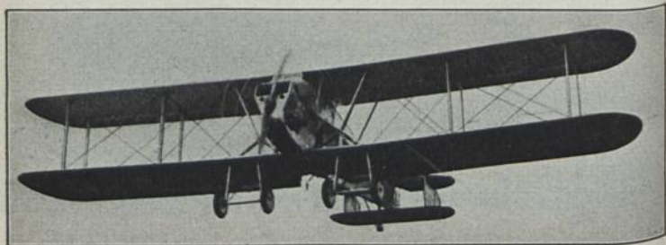
Blackburn „Cubaroo“ (1924) Kt 2; E: Bumpus b = 26,83 \text{ m} ; l = 16,47 \text{ m} ; L = 4,37 \text{ t} ; N = 4,27 \text{ t} ; G = 8,64 \text{ t} ; V = 185 \text{ km/h} ; M: \text{Napier } 1000 \text{ PS-HP-CV} ; Bst.: H, St, S.
