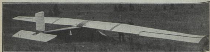
Graz „Vandale“ (1924); E: K. u. F. Pernthaler b = 15,50 \text{ m} ; T = 17,00 \text{ m}^2 ; l = 5,60 \text{ m} ; L = 120,0 \text{ kg} ; G = 190,0 \text{ kg} ; G/T = 11,2 \text{ kg/m}^2 ; Bst.: H. St.
