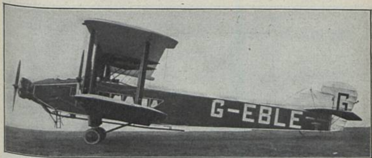
Handley Page W 9 „Hampstead“ (1925) V 16; E: F. Handley Page b = 24,17 \text{ m} ; l = 18,19 \text{ m} ; T = 145,4 \text{ m}^2 ; L = 4,15 \text{ t} ; N = 2,61 \text{ t} ; G = 5,76 \text{ t} ; V = 88-184 \text{ km/h} ; H = 4,1 \text{ km} ; St = 0,24 \text{ km/l'} ; M: 3 \times \text{Siddeley } 385 \text{ PS-HP-CV} = 1155 \text{ PS-HP-CV} ; Bst.: H, St, S.
