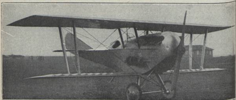
Gabardini G 9 bis (1925) K j 1; E: Gabardini b = 7,00 \text{ m} ; l = 6,00 \text{ m} ; T = 18,00 \text{ m}^2 ; M: Hispano 300 PS-HP-CV; Bst.: S. St.
