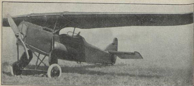
Junkers H 21 (1924) Ka 2; E: Junkers M: B. M. W. 185 PS-HP-CV; Bst.: D. Junkers-Werke, Moskau
