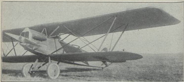
Aero A 30 (1926) Ka 2; E: Husnik, Vlasak M: Lorraine 450 PS-HP-CV; Bst.: H, S, St.
