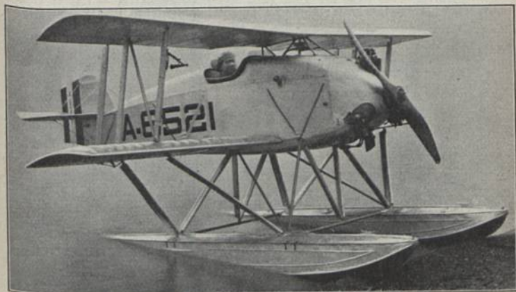
Gl. Martin M S-1 (1924) Kwa 1; E: G. Madelung b = 5,50 m; l = 5,35 m; L = 0,29 t; N = 0,13 t; G = 0,42 t; M: Lawrance 60 PS-HP-CV; Bst.: S, D.
