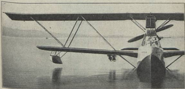
Macchi M 18 (1923) Ksa 2; E: G. Macchi M: Isotta 250 PS-HP-CV; Bst.: H. St.
