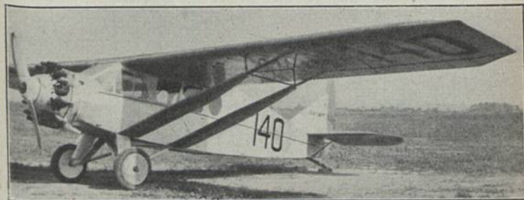
Huff Daland „Pacer“ (1927) V 6; E: G. Bellanca b = 13,70 \text{ m} ; l = 7,53 \text{ m} ; T = 25,30 \text{ m}^2 ; L = 0,81 \text{ t} ; N = 0,61 \text{ t} ; Q = 1,42 \text{ t} ; V = 218 \text{ km/h} ; M: Wright 200 PS-HP-CV; Bst.: H. S. St.
