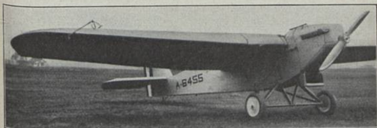
Gl. Martin MO-1-A (1923) Ka; E: G. Madelung L = 1,50 t; M: Curtiss 400 PS-HP-CV; Bst.: D.
