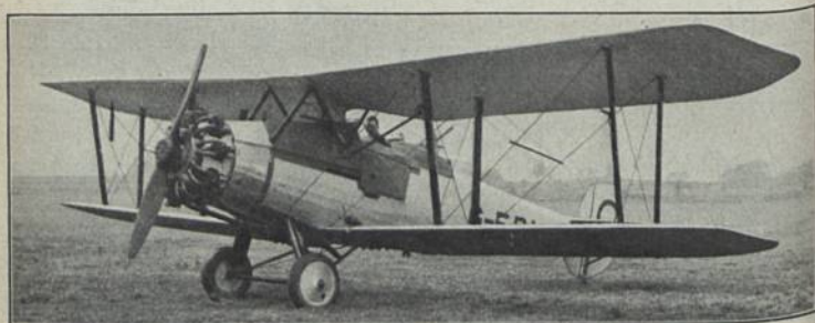
Bristol „Boarhound“ (1926) Ka 2; E: F. Barnwell M: Bristol 450 PS-HP-CV; Bst.: S, D, St.
