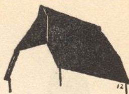
12. Geknicktes Walmdach: Dom in Güstrow
