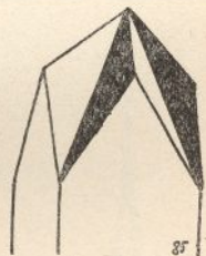
85. Roman. Viergiebel-turm mit Faltdach
