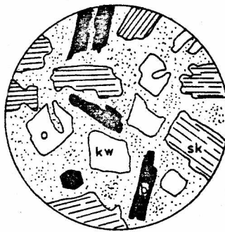
Rys.13. Riolit (powiększenie 24x): kw. - kwarc, sk. - skalenie, b - biotyt
