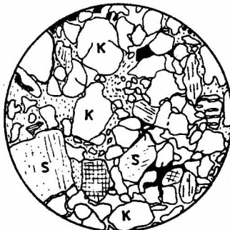
Rys.25. Piaskowiec arkozowy (powiększenie 14x). Widoczne są ziarna kwarcu (K) i skalenia (S) o różnym stopniu obtoczenia
