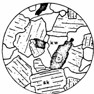
Rys.12. Granit (powiększenie 10x): kw. - kwarc, sk. - skalenie z widocznymi śladami żupliwości i wstępnymi procesami rozkładu, b - biotyt z widocznymi śladami żupliwości
