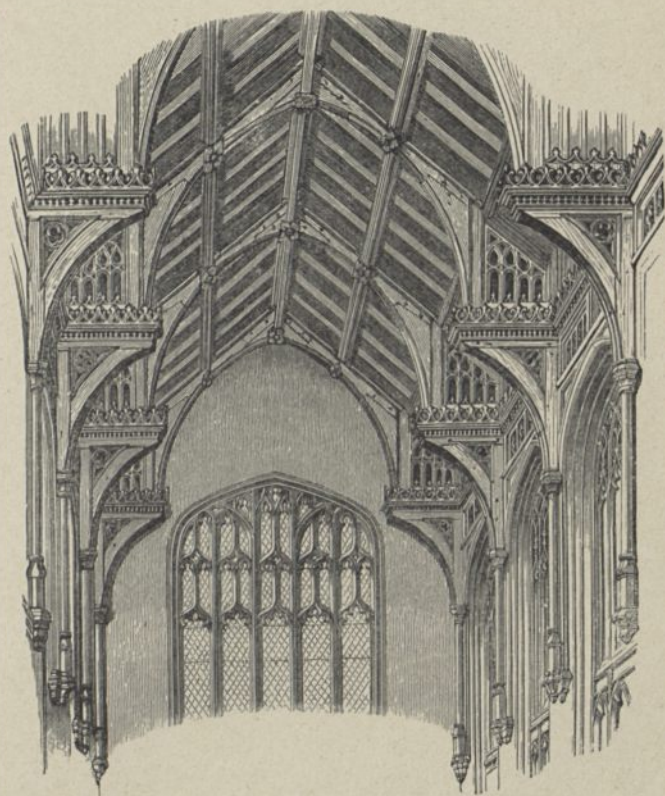
Fig. 149. Sklepienie drewniane w kościele w Norwich.
