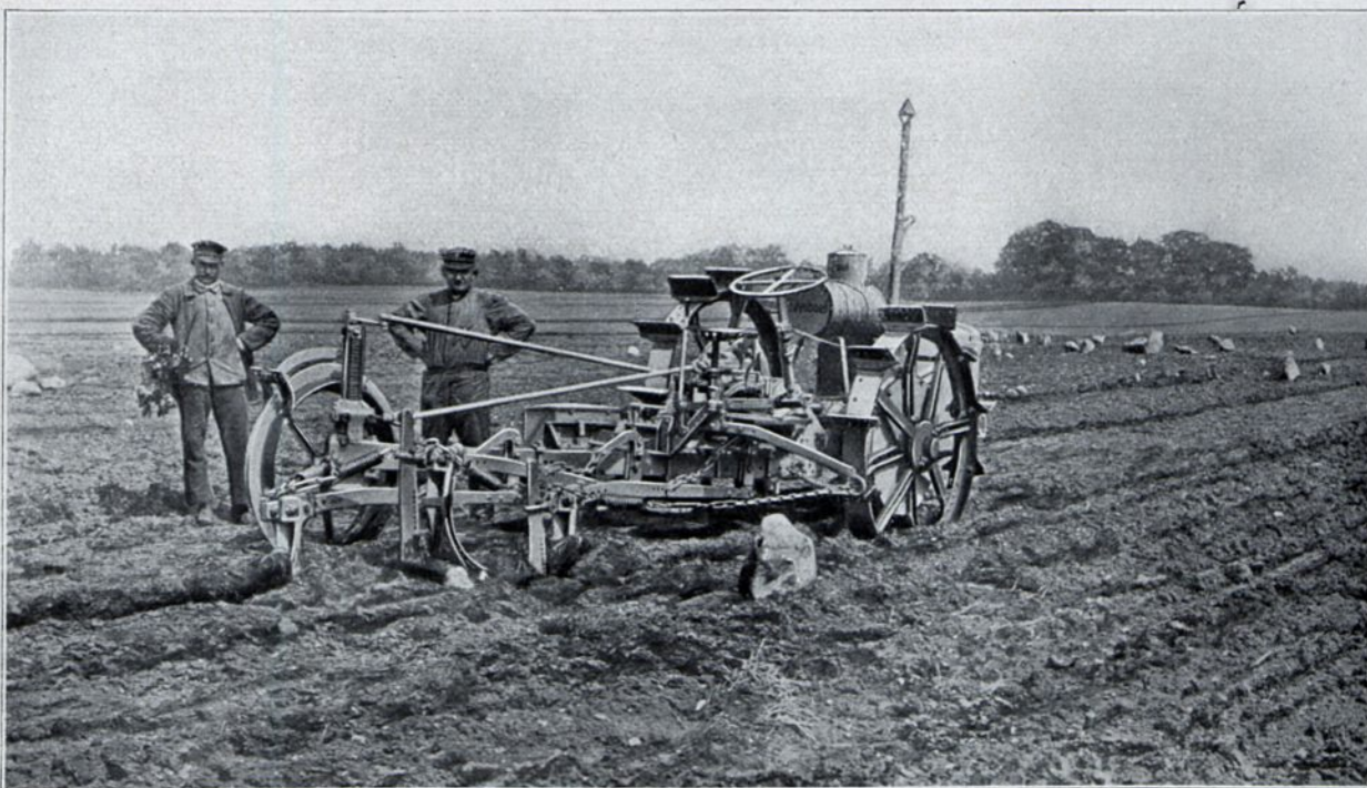
DREISCHAR-STOCKPFLUG 40 PS (STOKRAFT) Ausgerüstet mit Pendelkörpern und Untergrundlockerern für Untergrundkultur auf steinigén Böden Stock Motorpflug A.-G., Berlin SO
