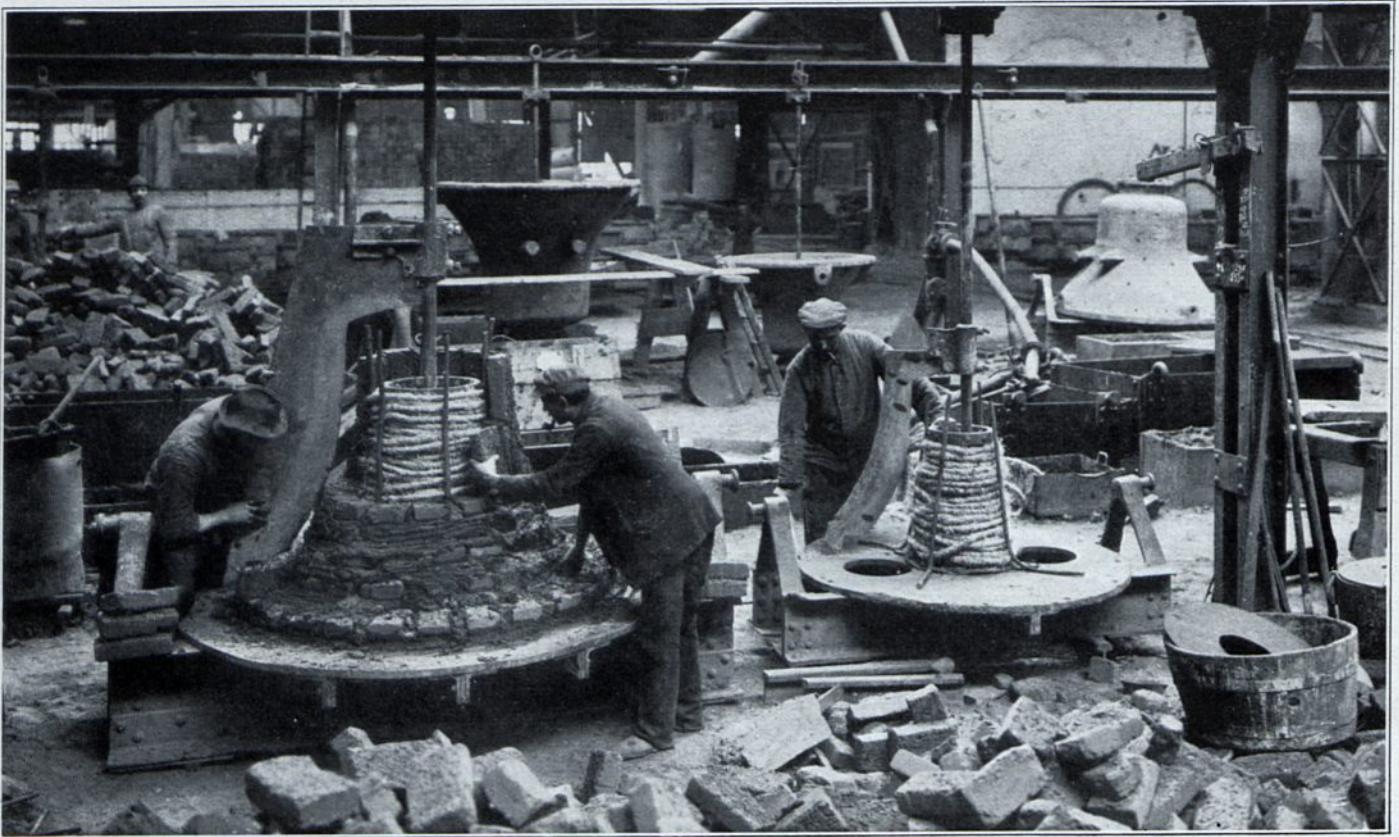
FORMUNG DES GLOCKENKERNS * AUFBAU DES MANTELS
