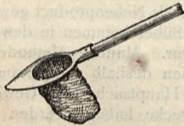
Spatenartiges Geräth mit Lederbeutel zum Ausstechen goldhaltigen Geschiebes unter Wasser.
