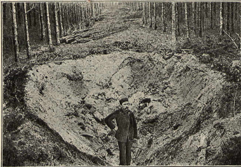
Trichter in Erde, welcher durch eine mit 14 kg Schiesswolle geladene 21 cm Granate gesprengt wurde.*)
