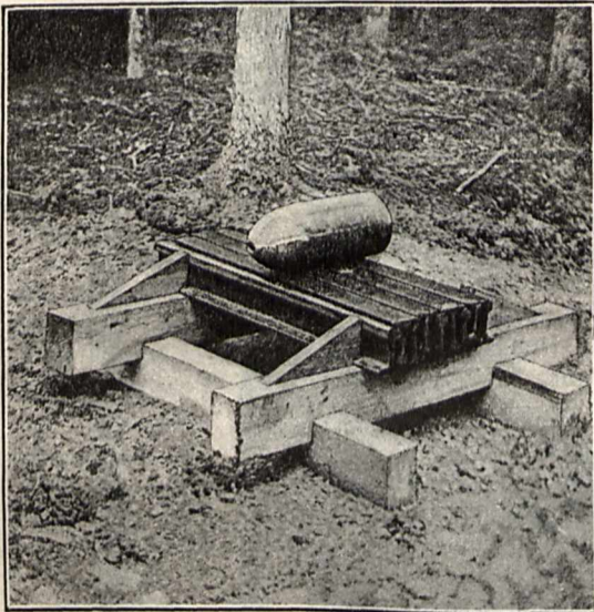
Sprengung einer doppelt gelegten Decke von Eisenbahnschienen durch eine mit 4,2 kg Schiesswoll-Kornpulver geladene 21 cm Granate. *)
