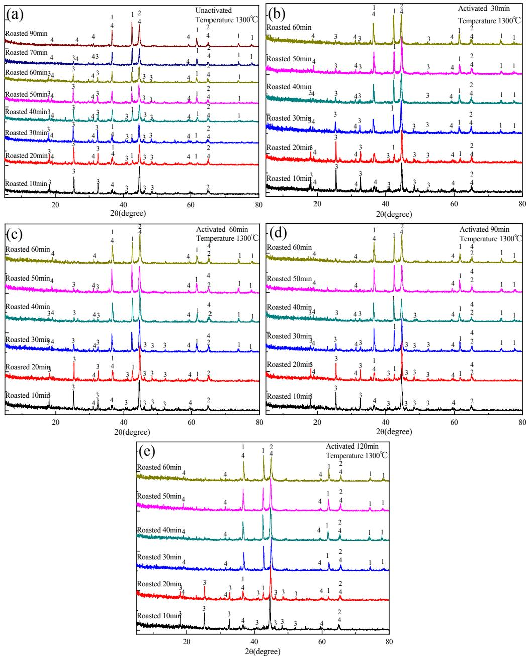
1-TiN, 2-Fe, 3- $M_3O_5$  ( $MgTi_2O_5$ ,  $FeTi_2O_5$ ,  $Ti_3O_5$ ), 4- $MgAl_2O_4$
