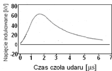
Rys.9. Napięcie indukowane na końcu linii.
