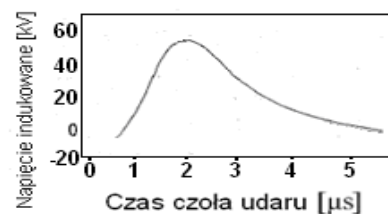
Rys.10. Napięcie indukowane na środku linii.
