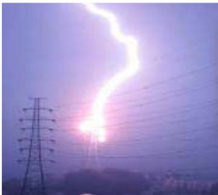
Rys. 7. Zarejestrowany przeskok odwrotny na izolacji słupa [105].
