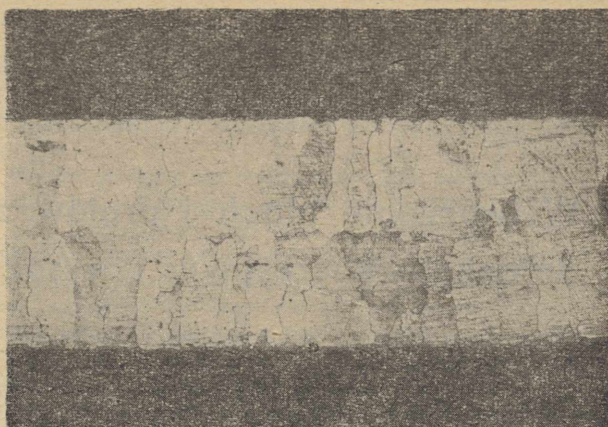
Rys. 4. Struktura blachy o grubości 3 mm z wytupu nr 3 po odwęglającej obróbce cieplnej. Traw. \text{HNO}_3 . Pow. 10\times
