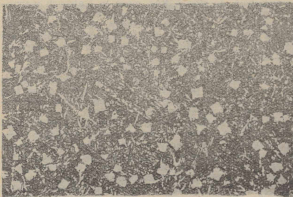
Rys. 2. Mikrobudowa stopu Ł83. Traw. elektrol. Pow. 100×
