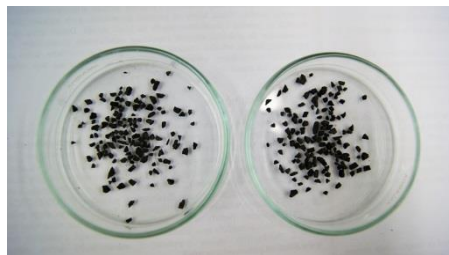
Rysunek 5. Fracje dolne łupka miedziowego uzyskane w wyniku rozdziału przy gęstości roztworu poliwolframanu sodu równej 2,58 \text{ g/cm}^3
