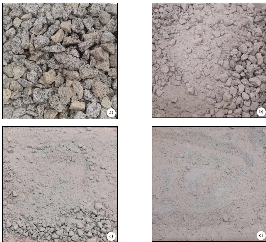
Rys. 1. Obrazy kruszywa granitowego I (frakcja 11,2–16 mm) rozdrabnianego z wykorzystaniem 10 kul: a) przed badaniem, b) po 500 obrotach bębna, c) po 1000 obrotach bębna, d) po 1500 obrotach bębna
