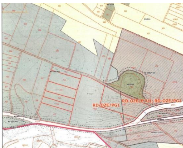
Rys. 12. MPZP dopuszczający działalność górniczą i PV jednocześnie
