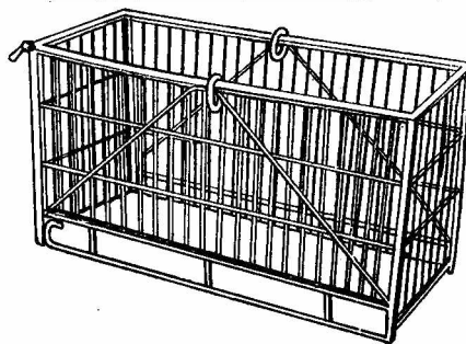
Rys. 5. Pojemnik systemu Malcewa z jednym dnem o łącznej wadze z materiałem 0,75 t.
