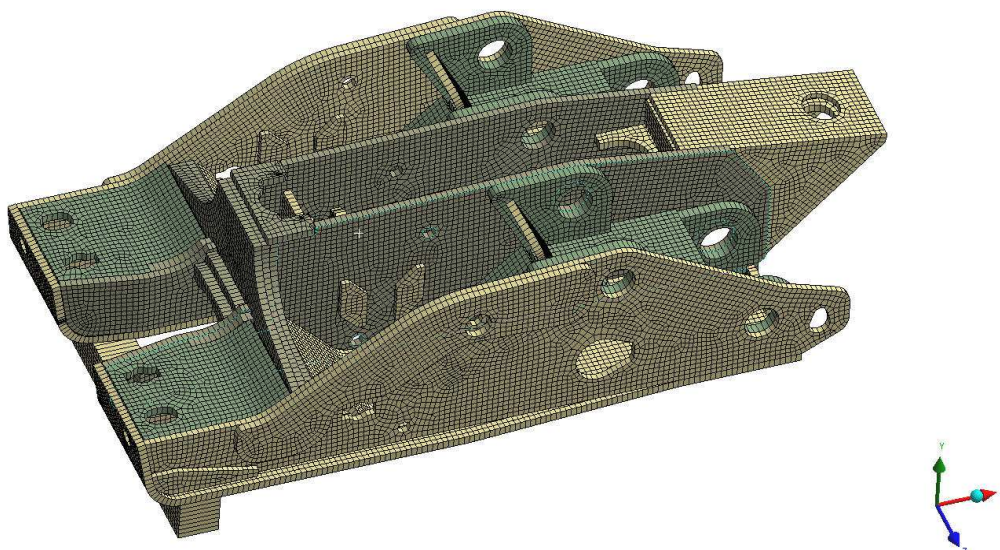
Rys. 2.15. Dyskretyzacja pojedynczego podzespołu sekcji FAZOS
