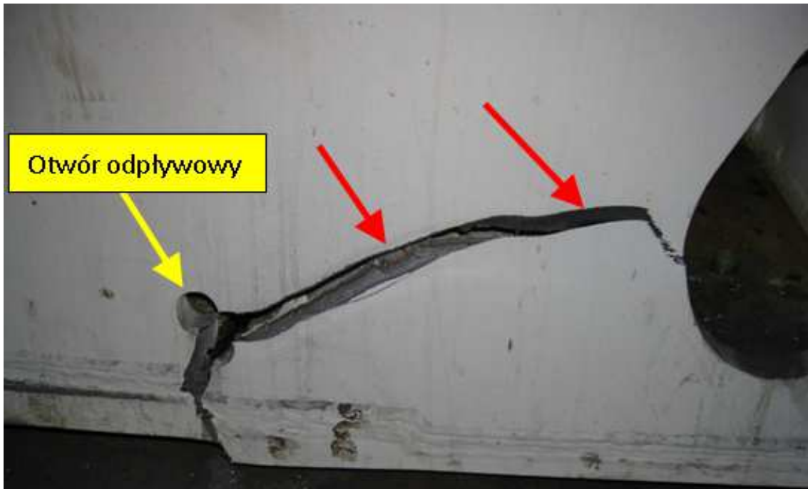
Rys. 6.12. Miejsce uszkodzenia spągnicy nr 1
