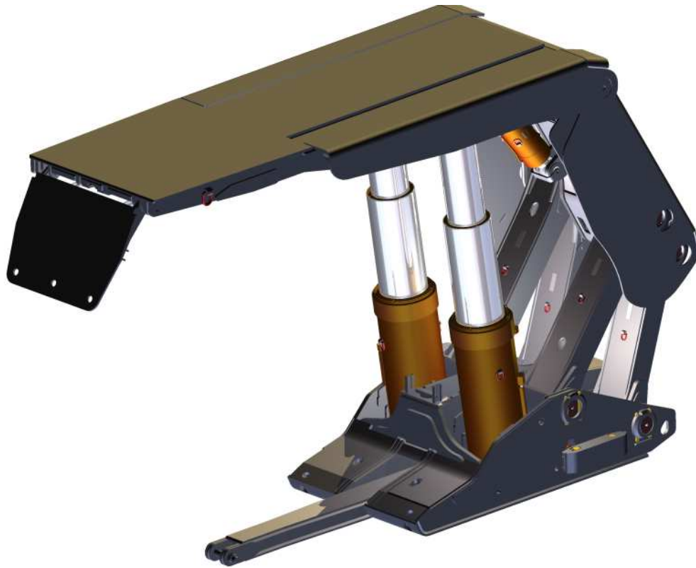
Rys. 2.8. Model obudowy FAZOS-18/38-2x6840 wykonany w programie INVENTOR
