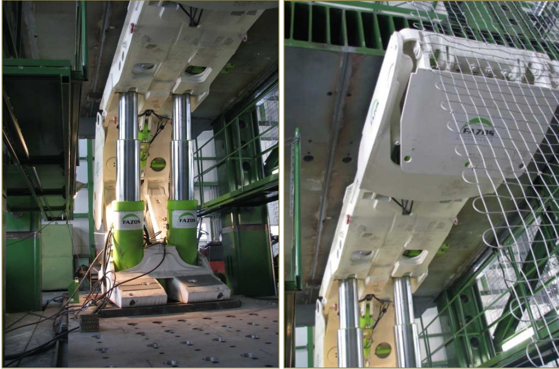
Rys. 2.4. Sekcja FAZOS-12/28-2x2980 podczas badań cyklicznych
