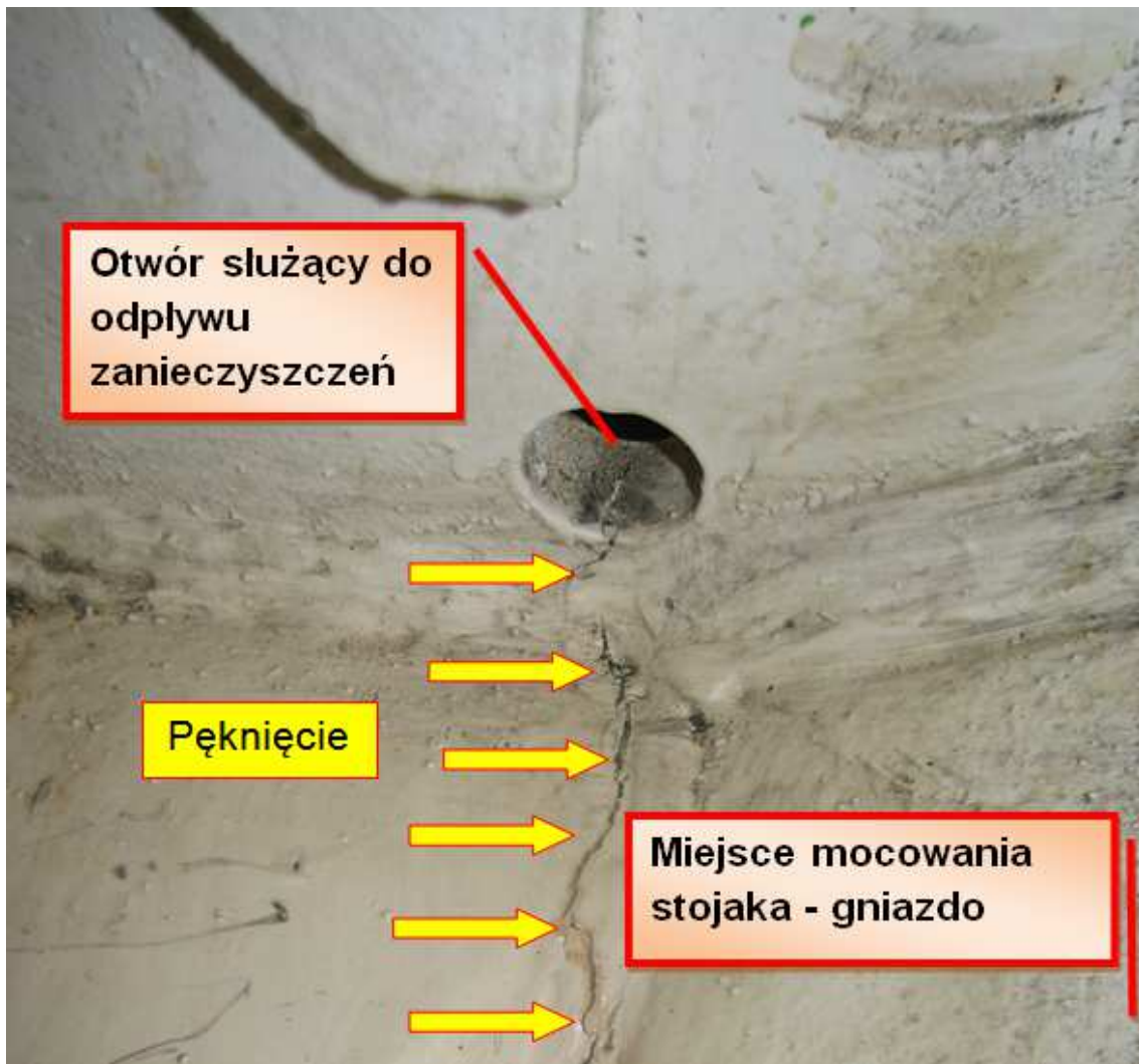
Rys. 3.1. Fragment spągnicy z przykładowym karbem geometrycznym inicjującym uszkodzenie
