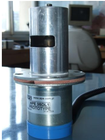
Rys. 6.5. Zmodyfikowany zawór EGR ze zintegrowanym mikrokontrolerem i czujnikiem położenia
