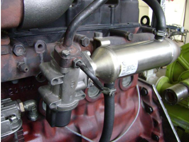
Rys. 6.4. Elementy standardowego układu recyrkulacji spalin z seryjnym zaworem EGR
