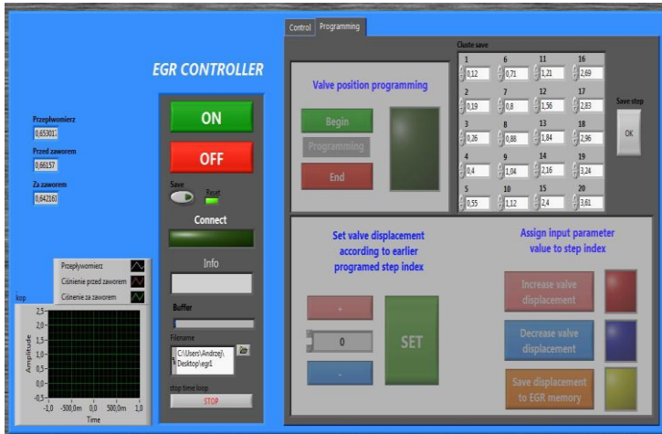
Rys. 6.9. Okno aplikacji programującej zawór EGR napisane w środowisku LabView
