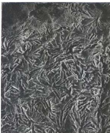
Rys. 8.10. Sferolityczna struktura warstwy wierzchniej nienapełnionego POM po tarceniu ze stalą w warunkach p = 1 MPa, v = 1 m/s; pow. \times 800 (1 cm = 50 \mu\text{m} )
