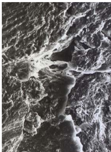
Rys. 8.18. Kompozyt: POM +12% objętościowo proszku PTFE + 20% objętościowo proszku brązu po tarcii ze stalą w warunkach: p = 5 \text{ MPa} , v = 1 \text{ m/s} ; a) – powierzchnia ślizgowa oraz nietrawiony przekrój warstwy wierzchniej, b), c) – trawiony przekrój warstwy wierzchniej; pow.: a) \times 100 (1 cm = 135 \mu\text{m} ), b) \times 800 (1 cm = 50 \mu\text{m} ), c) \times 3000 (1 cm = 13 \mu\text{m} )
