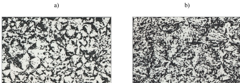
Rys. 3.8. Struktury sferolityczne POM powstałe ze stanu roztopionego (120 s w temperaturze 190 °C): a) w 150 °C, b) w 156 °C [133]
