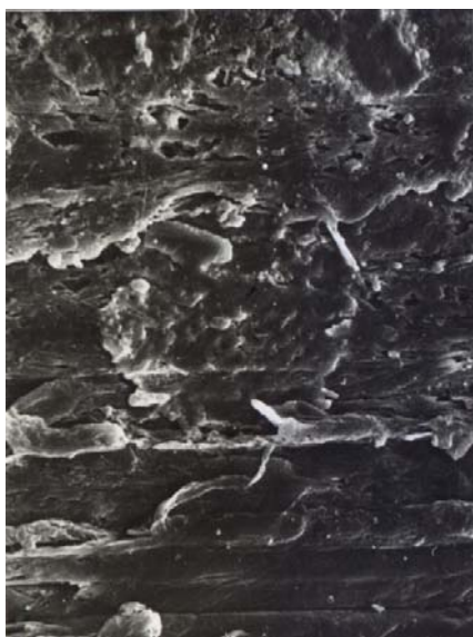
Rys. 8.19. Kompozyt: POM + 12% objętościowo proszku PTFE + 20% objętościowo proszku brązu po tarcu ze stalą w warunkach: p = 1 MPa, v = 3,3 m/s; a) powierzchnia ślizgowa oraz nietrawiony przekrój warstwy wierzchniej, b), c) trawiony przekrój warstwy wierzchniej; pow.: a) – \times 100 (1 cm = 135 \mu\text{m} ), b) \times 800 (1 cm = 50 \mu\text{m} ), c) \times 2000 (1 cm = 20 \mu\text{m} )
