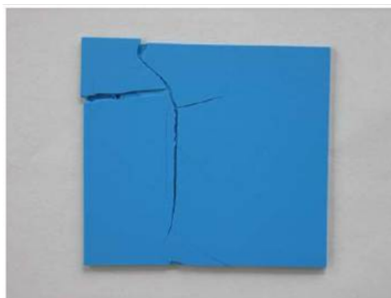
Rysunek 3.18: Uszkodzenie modułu ceramicznego, wykonanego metodą CLPL, zawierającego więcej niż cztery folie LTCC [46].
