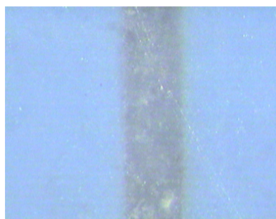
Rysunek 4.13: Kanał wykonany w ceramice LTCC wypełniony alkoholem cetylowym [107].
