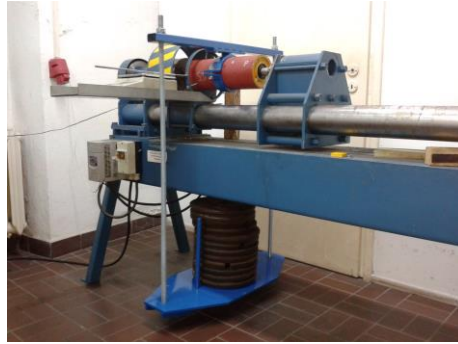
Rys. 2. Pomiar oporu obracania krążnika pod obciążeniem – widok z dodatkowymi obciążnikami Fig. 2. Measuring of rolling resistance of idler, view with additional load
