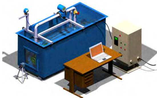
Rys. 6: Stanowisko pomiarowe do pompy o swobodnym przepływie
