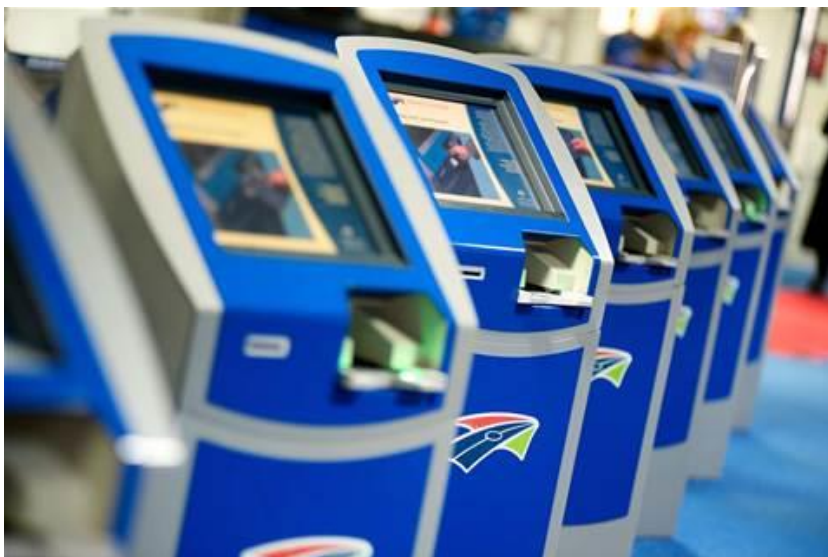
Rys. 5. Automaty Vision-Box do samodzielnego skanowania cech biometrycznych
