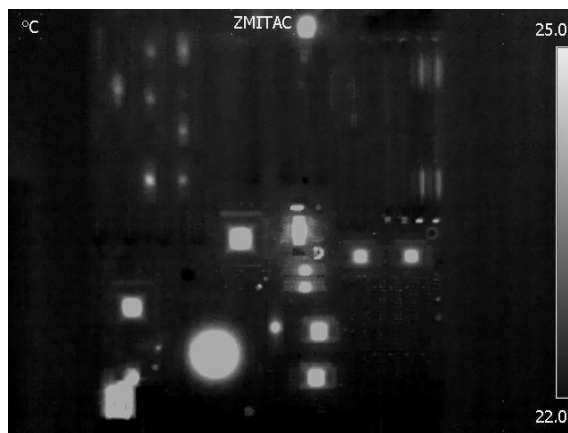
Rys. 4. Termogram układu elektronicznego wykonany po 10 sekundach działania układu
