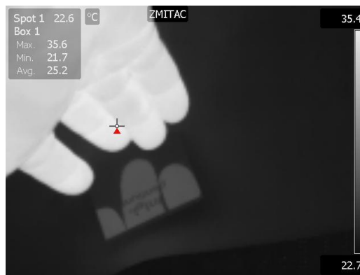
Rys. 1. Przykład odbicia termicznego na powierzchni procesora Intel Pentium
