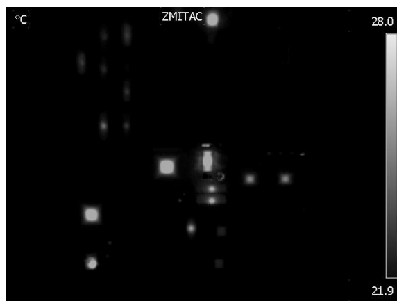
Rys. 5. Termogram układu elektronicznego ze źle zamkniętą dźwignią procesora
