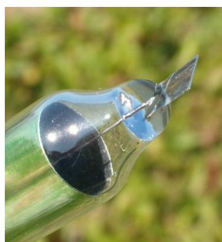
Rys. 2. Przykładowe konstrukcje elektrod stosowanych do pomiarów wartości potencjału redox
