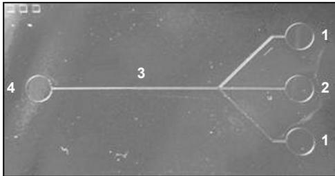
Fig. 8. PDMS microfluidic chip.
