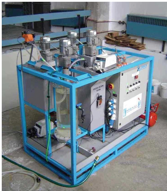
Rys. 5.6. Instalacja pilotowa systemu dwustopniowego o wydajności 0,5 \text{ m}^3/\text{h} [25]
