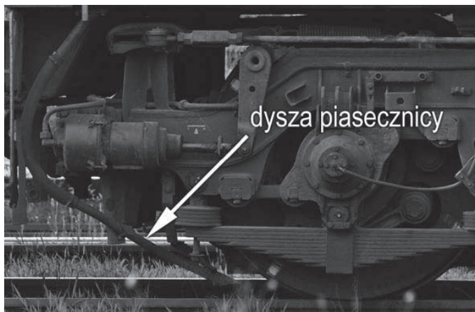
Rys. 4. Dysza piasecznicy lokomotywy serii ET41
